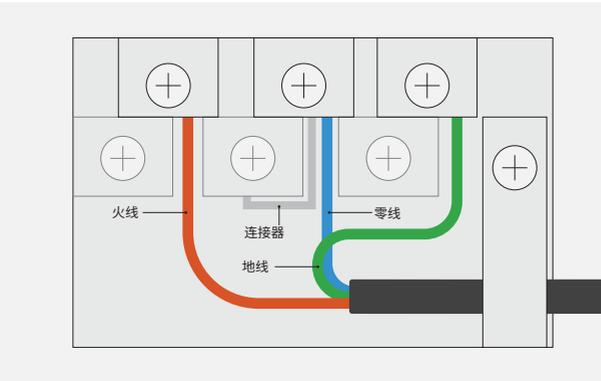
2. 根据您的接线端子配置，如图所示连接电线。并非所有型号都有连接器和端口。
