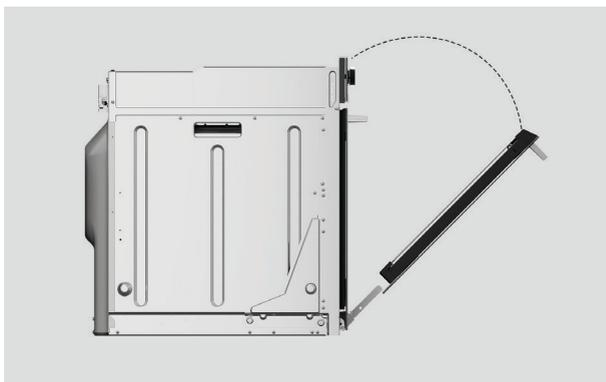
4. 双手握住门两侧让它回升到半关门状态，然后轻轻向外拉门使其脱离两边的铰链。
