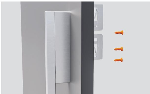
4. Fixer la poignée au panneau à l'aide de quatre vis à six pans creux M5x25.
