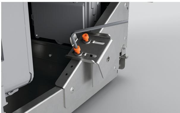
1. Desserrer les vis du support d'ajustement du capuchon des deux côtés de la plinthe à l'aide d'une clé Allen.
