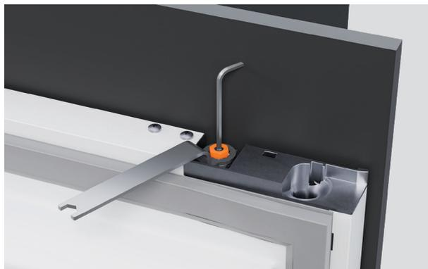
**5.** Serrer légèrement les vis latérales et les rondelles M8 supérieures en utilisant la clé et la clé en L fournies dans le kit d'installation.
