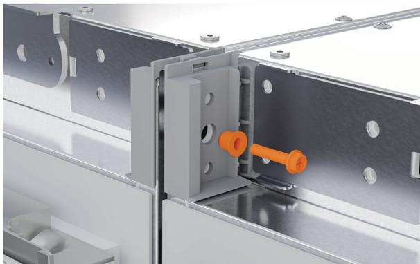
**3.** Fixer les supports supérieurs entre eux en installant d'abord le boulon M5 et le manchon de jonction fournis. Serrer à l'aide d'une douille de 8 mm et d'un tournevis cruciforme jusqu'à ce que le manchon affleure.
