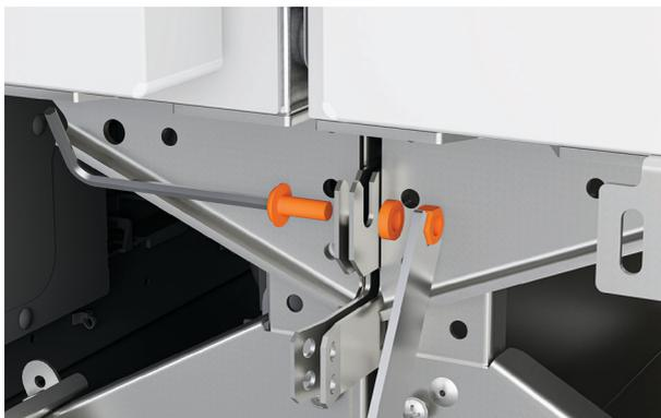
**2.** Fixer les supports inférieurs entre eux à l'aide de la vis M6 et de l'écrou fournis. Les fixer à l'aide d'une clé Allen de 4 mm et d'une clé de 10 mm.
