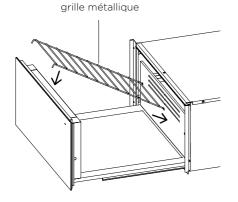
Insérez la grille métallique dans la partie gauche ou droite du tiroir chauffe-plat.
