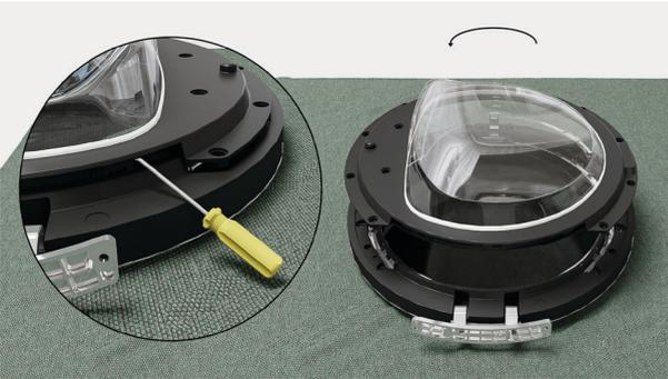
2. 将平头螺丝刀插入检修槽，撬开内门。将门旋转 180 度并安装回原位。
