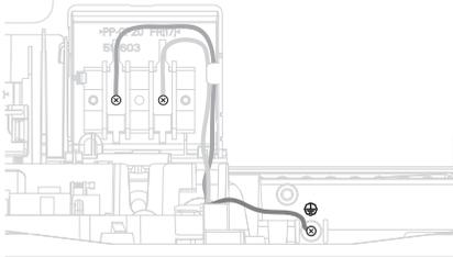
Fixez les fils sous tension et neutre au bornier et le fil de mise à la terre au châssis.
