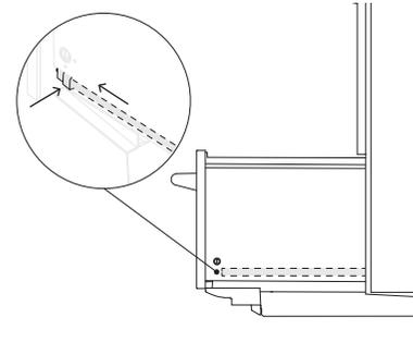
Assurez-vous que les tuyaux ne sont pas entortillés avant de réinstaller le tiroir sur les glissières et de l'enclencher en place à l'aide des deux languettes de verrouillage.
