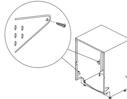
Fixez l'appareil aux armoires à l'aide des quatre emplacements de fixation dans le châssis.
