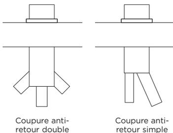
Installez votre ensemble de coupure anti-retour sur le comptoir. Nous recommandons d'utiliser un ensemble de coupure anti-retour double.
