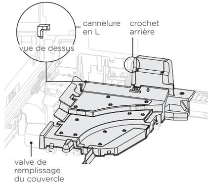
Positionnez la valve de remplissage du couvercle en place avant d'abaisser la partie restante du couvercle en position.
