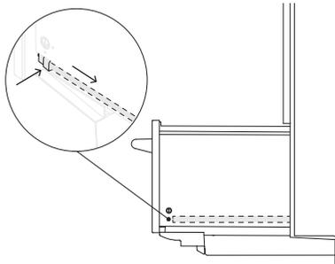
Ouvrez le tiroir inférieur et enfoncez les deux languettes de verrouillage vers l'arrière pour le libérer.
