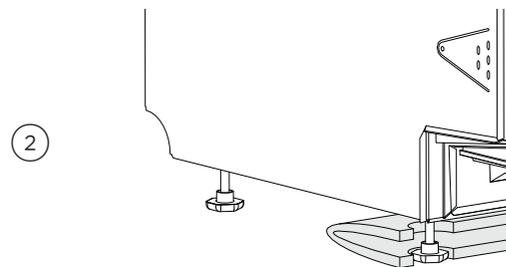
Inclinez délicatement le lave-vaisselle DishDrawer™ vers l'arrière et alignez l'isolant sur les pattes avant.
