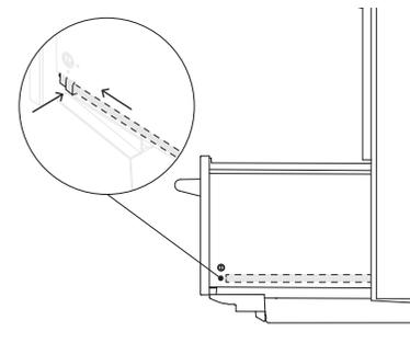
Réinstallez le tiroir sur les glissières et enclenchez-le en place à l'aide des deux languettes de verrouillage.
