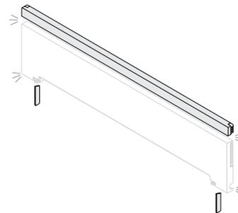
Retirez l'excédent de matériau de la plinthe et les deux languettes d'extrémité.
