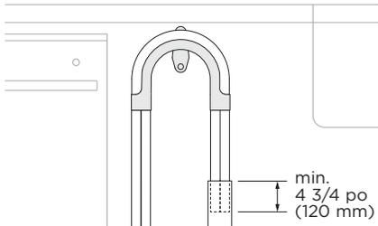
Faites passer les deux tuyaux dans le guide de support et déposez-les dans la conduite verticale.
