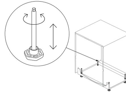
En utilisant la douille hexagonale fournie et un tournevis, mettez de niveau le lave-vaisselle DishDrawer™ selon les besoins. Tournez dans le sens des aiguilles d'une montre pour augmenter la hauteur de chaque patte, ou dans le sens inverse. Il peut être utile de réduire la charge sur les pattes pour faciliter le processus d'ajustement lors de la diminution de hauteur.
