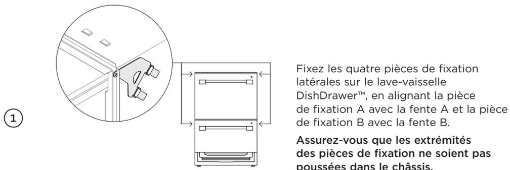
**Assurez-vous que les extrémités des pièces de fixation ne soient pas poussées dans le châssis.**
