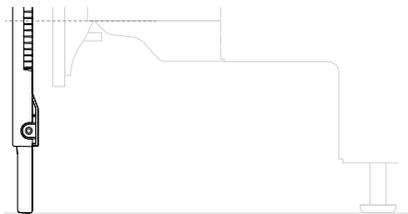
Mesurez la hauteur de plinthe contre la base de la cuve inférieure.
