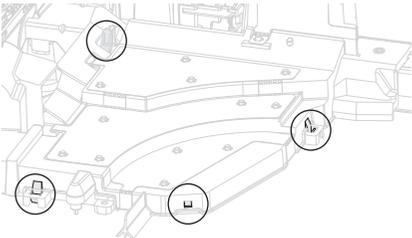
Réinsérez les clips en place en appuyant fermement sur le couvercle. Assurez-vous que toutes les zones illustrées soient enclenchées.
