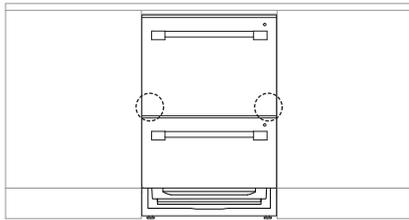
Poussez le produit dans la cavité, en faisant passer les tuyaux pendant que vous poussez pour éviter de les écraser ou les entortiller et en veillant à ne pas plier les pattes.
