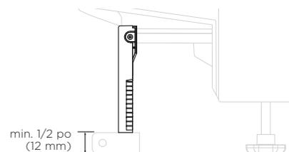
Glissez la plinthe sur les rails de fixation, puis fixez-la. Assurez-vous qu'un dégagement de 12 mm soit maintenu entre le plancher et la plinthe; les languettes d'extrémité peuvent être utilisées pour mesurer ce dégagement, si nécessaire.
