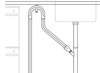
Faites passer les deux tuyaux dans le support de tuyau d'évacuation avant d'insérer les attaches métalliques sur les tuyaux et de les installer sur le raccord pour tuyau fourni. Fixez à l'aide des attaches métalliques.
