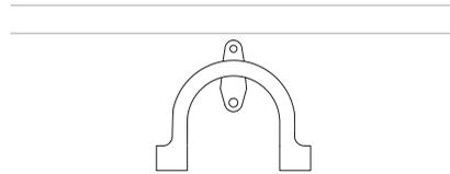
Installez le support de tuyau d'évacuation sur le mur arrière, aussi près que possible du dessous du comptoir. Reportez-vous à 'À prendre en considération pour les raccordements de plomberie et d'alimentation électrique' pour les hauteurs d'installation minimales.
