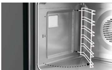
Tirez l'avant du rayon de manière à le dégager de la vis et faites-le glisser vers l'avant pour le retirer.
