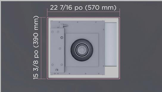
2. Créez une ouverture de 22 7/16 po x 15 3/8 po (570 x 390 mm) dans la base de la cavité pour le ventilateur externe.
