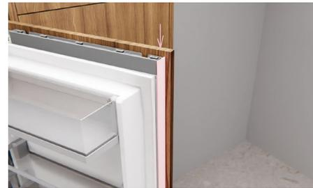
Localice la moldura de puerta más larga en el lado que no tiene la bisagra en el aparato y deslícela hacia abajo para acoplarla en su sitio. Si hay un hueco, retire y vuelva a ajustar los soportes laterales. Asegúrese de que la moldura no sobresale por encima de la cubierta superior.
