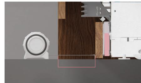
Empuje la puntera a la profundidad deseada antes de quitarla. Si la profundidad de la puntera es inferior a 90 mm, fije el bloque de espuma adicional.
