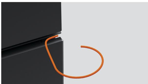
2. Insérez avec précaution l'ouvre-porte en haut à droite du four, entre la grille centrale et le haut de la porte.
