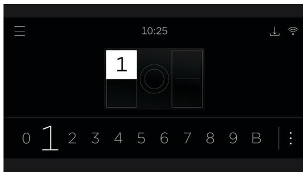
2. Utilizzare il selettore per impostare un livello di potenza. Selezionare 0 per spegnere la zona di cottura.
