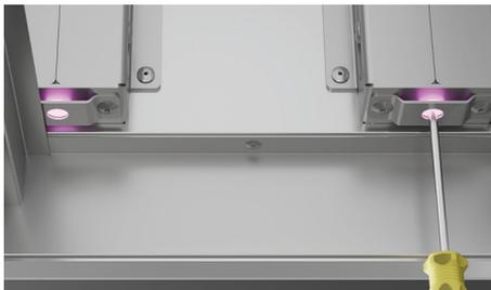
Desde la parte inferior de la campana extractora, asegure los cuatro soportes con un destornillador Phillips. Ajústelos hasta que la brida quede al ras contra el gabinete.
