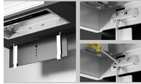
Vuelva a colocar la placa perimetral y asegúrala con los tornillos que retiró en el paso 3.
