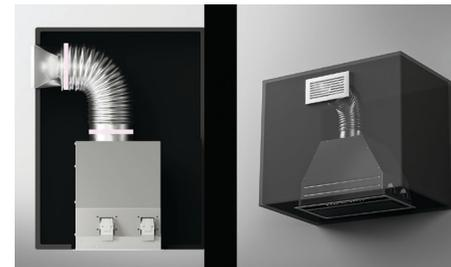
Conecte la salida del soplador a la ventilación con un conducto rígido de 6" (150 mm) y asegure las uniones con cinta de aluminio.
