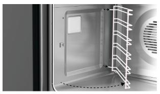
**3.** Tirez l'avant de la grille pour la dégager de la vis et faites-la glisser vers l'avant pour la retirer.
