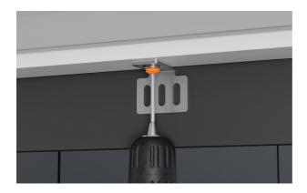
1. Con la puerta abierta, afloje el tornillo del soporte inferior. Ajuste el soporte para que descanse contra el panel de la puerta. Vuelva a apretar el tornillo del soporte.
