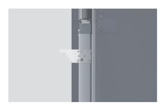
2. Marque el paso del medidor de profundidad en los lados de los gabinetes de las puertas según el espesor del panel de la puerta.
