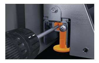
1. Ajuste la parte frontal del producto girando el tornillo izquierdo en sentido horario para bajar las patas.
