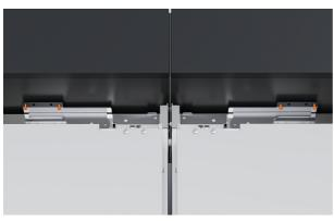
**6.** Ajuste los dos soportes superiores a los gabinetes utilizando dos tornillos avellanados 8Gx16 en cada lado.
