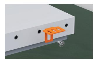
1. Desatornille el tornillo M6x25 para quitar el soporte de bloqueo del panel de la puerta y la arandela de la parte inferior de la puerta.
