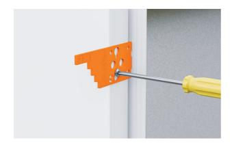
7. Coloque los medidores en los tornillos de la puerta. Empuje los medidores hacia abajo para bloquearlos en su posición antes de apretar el tornillo para asegurarlos.
