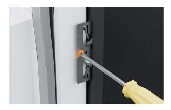
**7.** Coloque los tornillos laterales en el panel.
