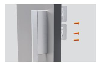
**4.** Coloca la manija en el panel con cuatro tornillos hexagonales M5x25.
