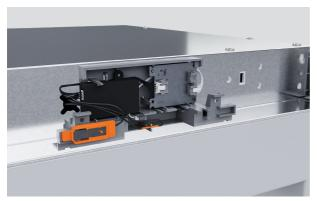
6. Coloque el sensor Hall en la carcasa del sensor en el bolsillo más cercano a la línea central del gabinete antes de presionar el arnés de la placa interceptora en las horquillas.
