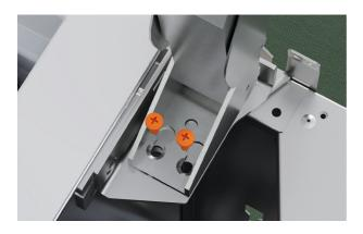
2. Inserte la bisagra superior quitada en las pestañas del soporte inferior. Gírelo en su lugar y asegúrelo con dos tornillos avellano M5x12.
