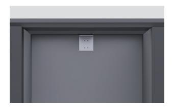
2. Mida la altura desde el piso hasta el voladizo delantero y márquela en la pared trasera. La altura de instalación del soporte antivuelcos no debe superar los 84 3/16" (2138 mm) para garantizar que el producto no se vuelque.
