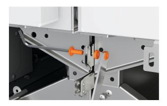
2. Asegure los soportes inferiores con el tornillo M6 y la tuerca suministrados. Asegure con una llave Allen de 4 mm y una llave inglesa de 3/8" (10 mm).
