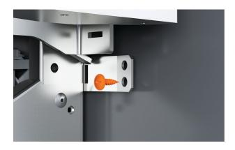
5. Coloca los dos soportes laterales inferiores en la superficie lateral del gabinete con un tornillo avellanado 8Gx16 en cada lado.
