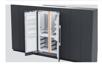
**4.** Presione la moldura central para fijar la posición.
