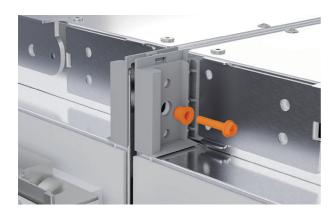
**3.** Sujete los soportes superiores ajustando el primer perno M5 suministrado y la manga de unión. Apriete con un dado de 5/16" (8 mm) y un destornillador Phillips hasta que el mango quede al ras.
