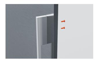
**3.** Coloca la manija en el panel con cuatro tornillos hexagonales M5x25.
