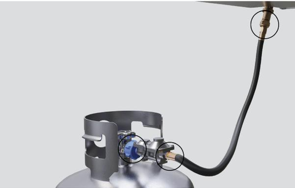
2. Aplique una solución jabonosa preparada con jabón líquido y agua en una proporción de 1:1 a todas las conexiones, mangueras y accesorios desde el cilindro hasta la conexión en la barbacoa.
