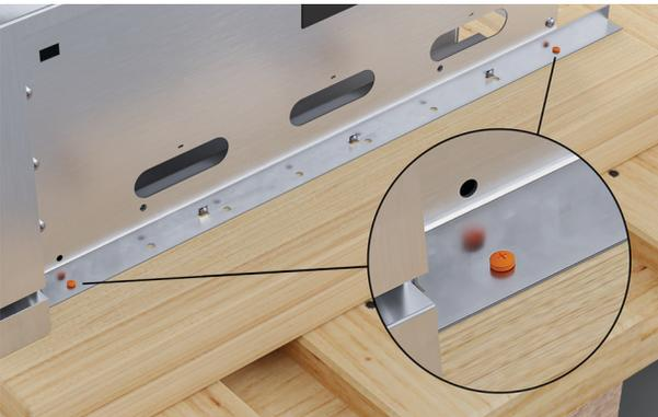
6. Afloje los tornillos Phillips que sujetan el soporte para transporte a la barbacoa. Levante el soporte para quitarlo y, a continuación, vuelva a ajustar los tornillos.
