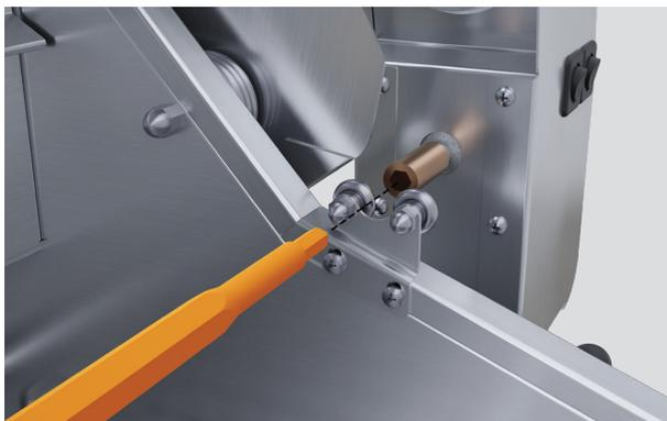
2. Introduzca con firmeza el extremo afilado de la varilla en el motor. Apoye el extremo opuesto en los rodillos al otro lado de la barbacoa.
