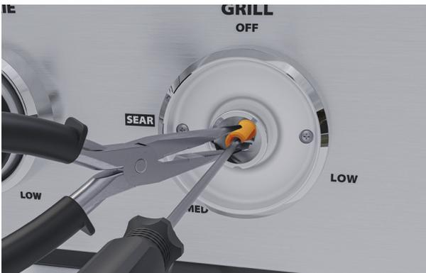
2. Sujete el eje de la válvula de control con unos alicates e inserte un destornillador plano largo y delgado. Gire en sentido horario para bajar la llama y en sentido antihorario para aumentarla.
