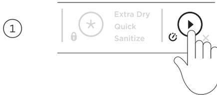
Maintenez la touche ► enfoncée pour régler la durée de mise en marche différée. Chaque signal sonore indique un délai de 1 h.
