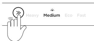
Appuyez sur » pour modifier le réglage d'une option. Les voyants de programme de lavage indiquent le réglage sélectionné.
