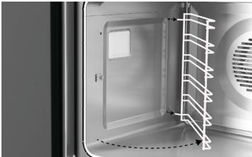
Tirez l'avant de la grille pour la dégager de la vis et faites-la glisser vers l'avant pour la retirer.
