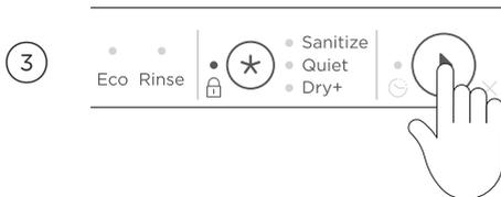
Drücken Sie **▶** innerhalb von 10 Sekunden und schließen Sie die Schublade, um das Spülprogramm zu starten.
