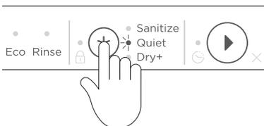
Drücken Sie ✱, um durch die verfügbaren Spülmodifikatoren zu blättern; die Anzeige des ausgewählten Spülmodifikators leuchtet auf der Anzeige.
