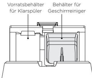
Geben Sie pulverförmigen Geschirreiniger in den Behälter für Geschirreiniger und schließen Sie den Deckel vorsichtig, bis er einrastet.
