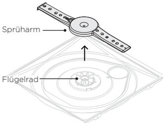
Heben Sie bei entfernten Ablagen den Sprüharm vom Flügelrad ab, indem Sie ihn von der Mitte aus nach oben ziehen. Ausschütteln, um lose Partikel zu lösen, unter fließendem Wasser abspülen und mit einem feuchten Tuch abwischen. Stellen Sie sicher, dass der Magnet sauber und frei ist und dass Wasser durch alle Löcher fließen kann.
