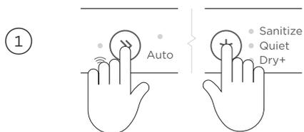
Überprüfen Sie, dass gerade kein Spülprogramm läuft, und öffnen Sie dann die Schublade. Halten Sie » und \* zusammen 4 Sekunden lang gedrückt.
