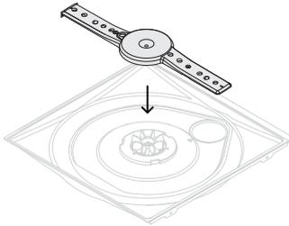
Setzen Sie den Sprüharm auf das Flügelrad. Stellen Sie sicher, dass sich der Sprüharm beim Wiedereinbau frei dreht.
