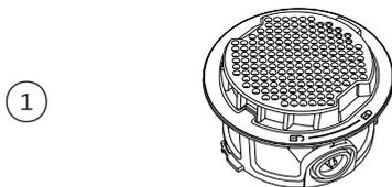
Richten Sie die Siebkappe auf die Kerbe am Siebunterteil aus. Zum Befestigen zusammenklicken.
