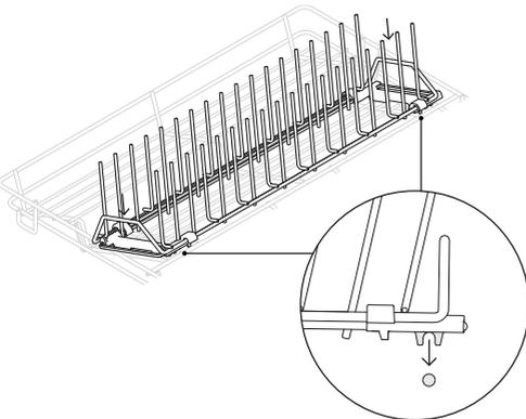
Richten Sie die vorderen und hinteren Clips am Grundgestell aus und rasten Sie sie ein.
