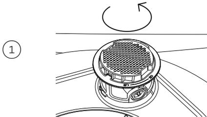
Drehen Sie das Sieb gegen den Uhrzeigersinn, bis der Pfeil in der Wanne auf
