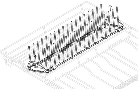
Fassen Sie die vorderen und hinteren Griffe und ziehen Sie sie nach oben, um sie zu lösen.
