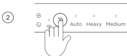
Drücken und halten Sie » , um eine Verbindung mit dem drahtlosen Heimnetzwerk herzustellen.
