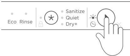
Drücken und halten Sie ►, jeder Signalton weist auf eine weitere Stunde Verzögerung an und kann für bis zu 12 Stunden eingestellt werden.
