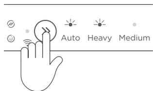
Drücken Sie auf », um die Einstellung einer Option zu ändern. Die Spülprogramm-Anzeige zeigt die ausgewählte Einstellung an. Weitere Einzelheiten dazu finden Sie im Abschnitt „Einstellungsanzeigen“.
