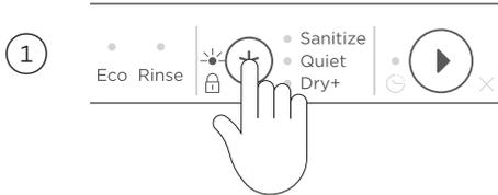
Öffnen Sie die Schublade und halten Sie **★** gedrückt, bis ein Signalton ertönt und die Sperranzeige zu blinken beginnt.
