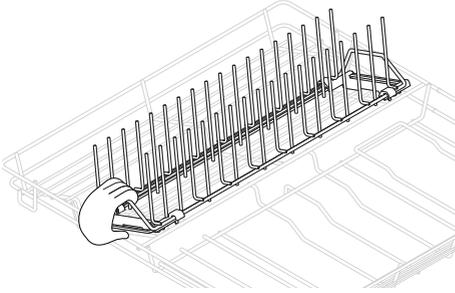
Schieben Sie die Spiker nach hinten oder vorne, indem Sie den vorderen Griff drücken oder ziehen.
