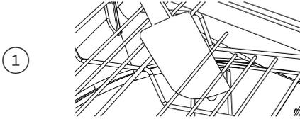
Vergewissern Sie sich, dass sich der Sprüharm frei drehen kann und keine Gegenstände unter der Ablage herausragen.
