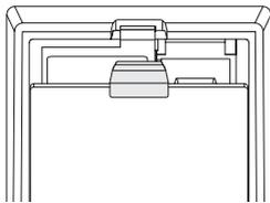
Drücken Sie die Verriegelung nach unten, um den Behälter für pulverförmige Reinigungsmittel zu öffnen. Prüfen Sie, ob der Behälter für pulverförmige Reinigungsmittel leer und trocken ist.
