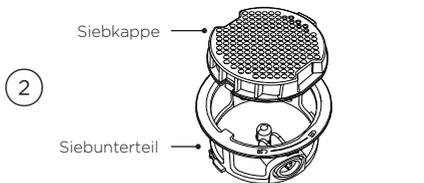
Trennen Sie die Siebkappe vom Siebunterteil, indem Sie den Entriegelungsknopf drücken und anheben.
