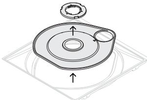
Entfernen Sie das Sieb, den Sprüharm, die Sicherungsmutter und die Siebplatte vom Boden der Schublade. Verwenden Sie einen Schwamm, um verbleibendes Wasser von der Unterseite zu entfernen, bevor Sie es wieder einsetzen.
