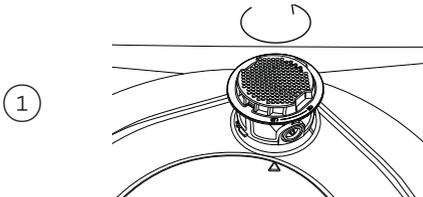
Reinigen Sie das Sieb. Siehe „Entfernen und Reinigen des Siebs“ für weitere Anweisungen.
