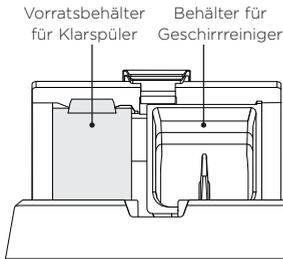
Der Vorratsbehälter für Klarspüler befindet sich an der Innenseite der Schublade neben dem Behälter für pulverförmige Geschirrrreiniger. Der Behälter fasst ca. 80 ml Klarspüler.
