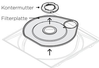
Drehen Sie bei abgenommener Ablage, Ablaufsieb und Sprüharm die Sicherungsmutter gegen den Uhrzeigersinn und heben Sie sie heraus. Heben Sie die Siebplatte vorsichtig heraus, reinigen Sie sie unter heißem Seifenwasser und spülen Sie sie gründlich ab. Vergewissern Sie sich, dass der O-Ring noch an seinem Platz ist, wie unten abgebildet.
