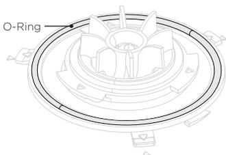
**Vergewissern Sie sich vor dem Wiedereinbau der Siebplatte, dass der O-Ring wie abgebildet korrekt in der Wanne positioniert ist. Wenn der O-Ring vor dem Ausführen eines Spülprogramms nicht korrekt montiert ist, kann das Produkt beschädigt werden.**
