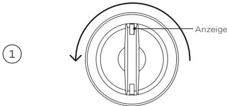
Drehen Sie die Kappe zum Abnehmen gegen den Uhrzeigersinn.
