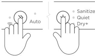
Überprüfen Sie, dass gerade kein Spülprogramm läuft, und öffnen Sie dann die Schublade. Halten Sie » und ✱ zusammen 4 Sekunden lang gedrückt.
