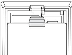
Drücken Sie die Verriegelung nach unten, um den Behälter für pulverförmige Reinigungsmittel zu öffnen, bevor Sie die Abdeckung des Vorratsbehälters für Klarspüler anheben.
