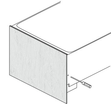
Insérez un tournevis à pointe étoilée dans le trou au-dessus de chaque tige latérale et tournez pour ajuster l'alignement du panneau. La distance de déplacement maximale est de  $\pm 1/16$  po (2 mm).
