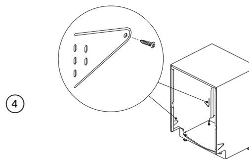
4 Fixez l'appareil aux armoires à l'aide des quatre emplacements de fixation dans le châssis.
