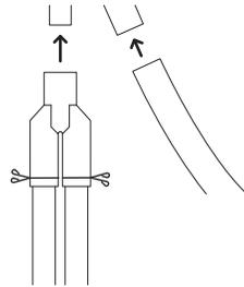
Insérez les attaches métalliques sur les tuyaux avant de les installer sur le raccord pour tuyau. Fixez à l'aide des attaches métalliques. Installez le raccord sur l'ensemble de coupure anti-retour et fixez-le à l'aide du collier de serrage. Assurez-vous que les tuyaux s'insèrent en ligne droite dans le raccord, en enlevant tout excédent du tuyau d'évacuation, si nécessaire.
