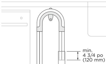
Faites passer les deux tuyaux dans le guide de support et déposez-les dans la conduite verticale. Assurez-vous que le tuyau d'évacuation n'atteigne pas l'eau contenue dans le siphon; un espacement est requis pour éviter que l'eau usée soit siphonnée vers la cuve.
