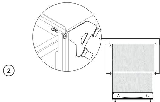
2 Fixez l'appareil aux armoires à l'aide des pièces de fixation. Il pourrait être nécessaire de pré-percer un avant-trou, selon le matériau des armoires.
