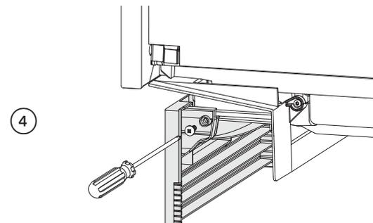
Glissez la plinthe sur les rails de fixation, puis fixez-la. **Ne serrez pas excessivement les vis.**
