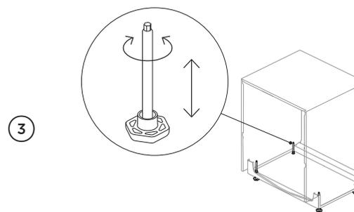
3 En utilisant votre main ou la douille hexagonale fournie et un tournevis, mettez de niveau le lave-vaisselle DishDrawer™ selon les besoins. Tournez dans le sens des aiguilles d'une montre pour augmenter la hauteur de chaque patte, ou dans le sens inverse pour la diminuer.
