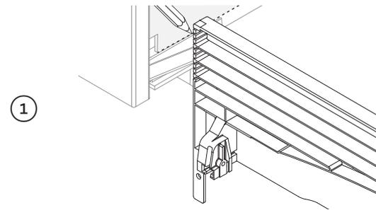
Mesurez la hauteur de la plinthe. Le point de découpe recommandé se situe à l'endroit où la plinthe rencontre le bas de la cuve.
