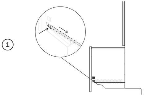
1 Ouvrez le tiroir inférieur et enfoncez les deux languettes de verrouillage vers l'arrière pour le libérer.
