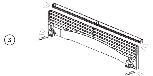
Retirez l'excédent et limez les rebords. Retirez les deux languettes d'extrémité.
