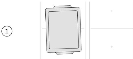
把平底锅放在炉灶上要使用的两个灶头上，让锅底同时盖住两个灶头。
