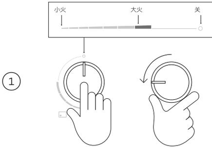
往里推旋钮，然后把旋钮反时针打到最大火力设置。在灶头点燃之后，继续按住旋钮3秒钟。
