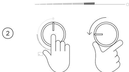
往里推旋钮，然后把旋钮反时针打到最大火力设置。在灶头点燃之后，继续按住旋钮3秒钟。
