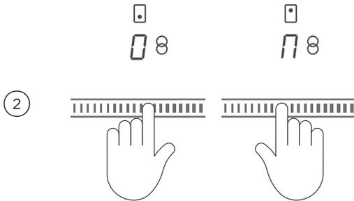
同时按两个灶头的设置选择器的任何部位。两个控制显示器都显示8符号，其中左边的显示器显示0，右边的显示器显示1符号。
