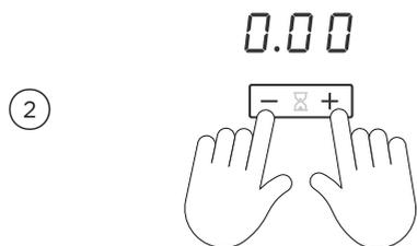
同时按 - 按钮和 + 按钮，直到所选灶头指示灯亮，然后设置时间。在滚动显示灶头时，只显示正在使用的灶头的指示灯。
