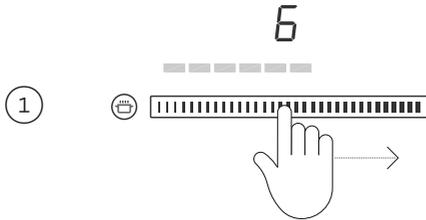
在接通灶头电源之后，按或滑动设置选择器到希望的设置降低灶头温度。
