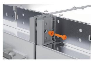
3. Fixez les supports supérieurs ensemble en installant le premier boulon M5 et le premier manchon de liaison fournis. Serrez à l'aide d'une douille 5/16" (8 mm) et d'un tournevis cruciforme jusqu'à ce que le manchon soit encastré.
