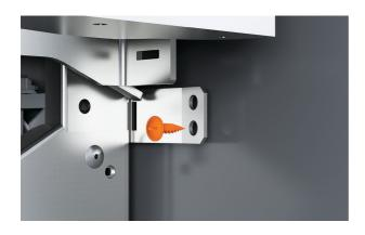
**5.** Fixez les deux supports latéraux inférieurs à la surface latérale des armoires à l'aide d'une vis à tête fraisée 8Gx16 de chaque côté.
