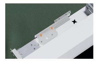
**5.** Sur le côté sans charnière, installez un nouveau support d'alcôve à l'aide de vis à tête fraisée M6x16.
