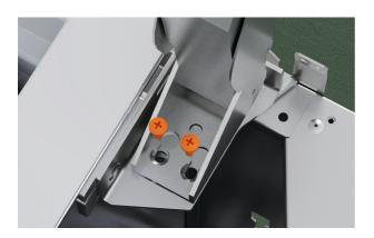
2. Insérez la charnière supérieure retirée dans les languettes du support inférieur. Tournez-la en place et fixez-la à l'aide de deux vis à tête fraisée M5x12.
