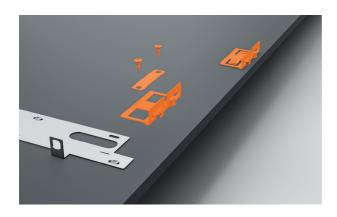
**3.** Alignez les supports latéraux sur le panneau. Fixez à l'aide des vis fournies. Assurez-vous que les supports latéraux soient installés solidement et que les fixations soient bien droites.
