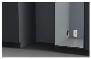
3. Assurez-vous que les services sont accessibles et correctement installés. Si les connexions sont situées derrière l'appareil, il est recommandé d'utiliser un interrupteur de sectionnement.
