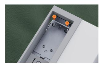
1. Réinstallez le support de la charnière supérieure et la pièce d'espacement avec les vis à tête fraisée M5x12 sur le nouveau côté des charnières.
