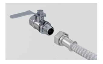
1. Raccordez une extrémité d'un tuyau tressé au robinet. Rincez le tuyau avant de le raccorder pour éliminer les débris.
