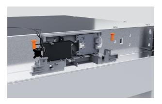
5. Réinstallez le compartiment de capteur à l'aide de deux vis #8x16 dans les trous prépercés du panneau supérieur de l'armoire.
