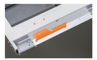
**5.** Sur le côté sans charnière, retirez le support d'alcôve en dévissant les vis à tête fraisée M6x16.
