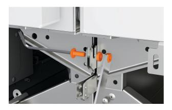
2. Fixez les supports inférieurs ensemble à l'aide de la vis et de l'écrou M6 fournis. Sécurisez à l'aide d'une clé Allen de 4 mm et d'une clé 3/8 " (10 mm). Assurez-vous que les supports
