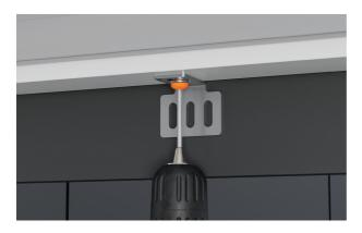
1. Avec la porte ouverte, desserrez la vis du support inférieur. Ajustez le support contre le panneau de porte. Serrez à nouveau la vis du support.
