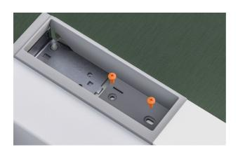
**3.** Dévissez les vis à tête fraisée M6x16 de la cavité de charnière pour retirer la cavité de charnière et le support d'alcôve supérieur.
