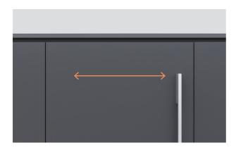
**6.** Poussez le panneau d'un côté à l'autre pour l'ajuster à l'horizontale. Assurez-vous que les panneaux sont au même niveau que le devant des armoires.
