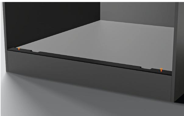
1. Centrez la pièce d'espacement noire dans la cavité, en alignant le bord plat avec l'avant de l'armoire.
