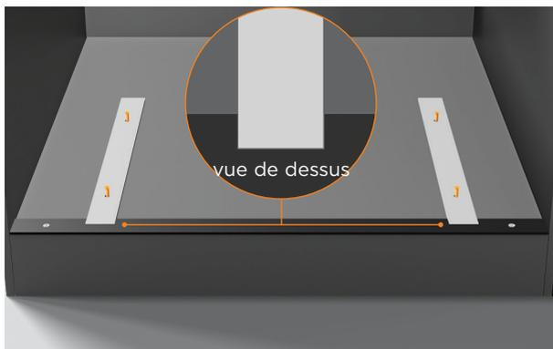
2. Placez les deux pièce d'espacement latérales en place. Assurez-vous que les pièces d'espacement sont uniformément espacés à l'avant et à l'arrière de la cavité.
