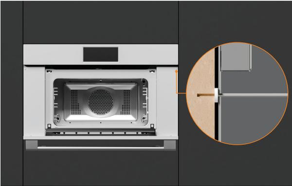
1. En utilisant le produit comme guide, pré-percez des trous pilotes de 2 x 3 mm.
