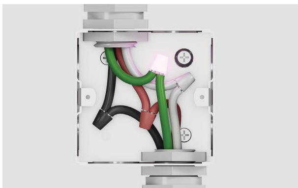
5. Connectez le câble de mise à la terre au fil de mise à la terre (vert) dans la boîte de jonction. Ne connectez pas le fil de mise à la terre vert au fil neutre (blanc) dans la boîte de jonction.
