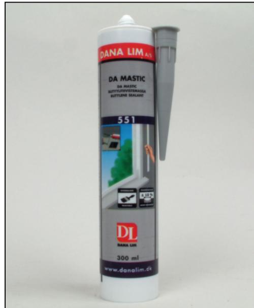
Damastic 551 är en oljebaserad plastisk fogmassa, som bildar en elastisk hinna på ca 1 mm, och fortsätter vara mjuk och plastisk under hinnan. Fogmassan kan övermålas, är lätt att bearbeta och bildar en fog som kan klara rörelse upp till +/- 10 %.
