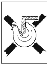
Kuva 4 d Koukun kärkeen vaikuttaa lisäksi vääntävä kosketusrasitus!
