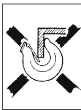
Fig 4 d Krokspetsen dessutom utsatt för böjpåkänning!
