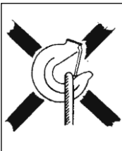
Fig. 4 a Slyngen belaster krokspissen!
