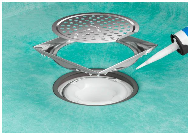
Efter montering av tätskikt är det viktigt att sätta ramen efter önskad riktning på ytskiktet. Ramen placeras centralt ovanför klärringen, säkerställ att vattenlåset går att lyfta ur. Ramen ska sedan punktlimmas med konstruktionslim på undersidan för att fästas på tätskiktet.
