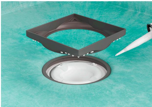
Vedeneristyskerroksen asentamisen jälkeen on tärkeää asettaa kehys laatoituksen mukaiseen suuntaan. Kehys sijoitetaan kaivon keskelle kiristysrenkaan yläpuolelle siten, että vesilukko on mahdollista poistaa kaivosta. Kehys kiinnitetään alapinnastaan pisteliimaamalla märkätiloihin sopivalla rakennusliimalla vedeneristeen päälle.
