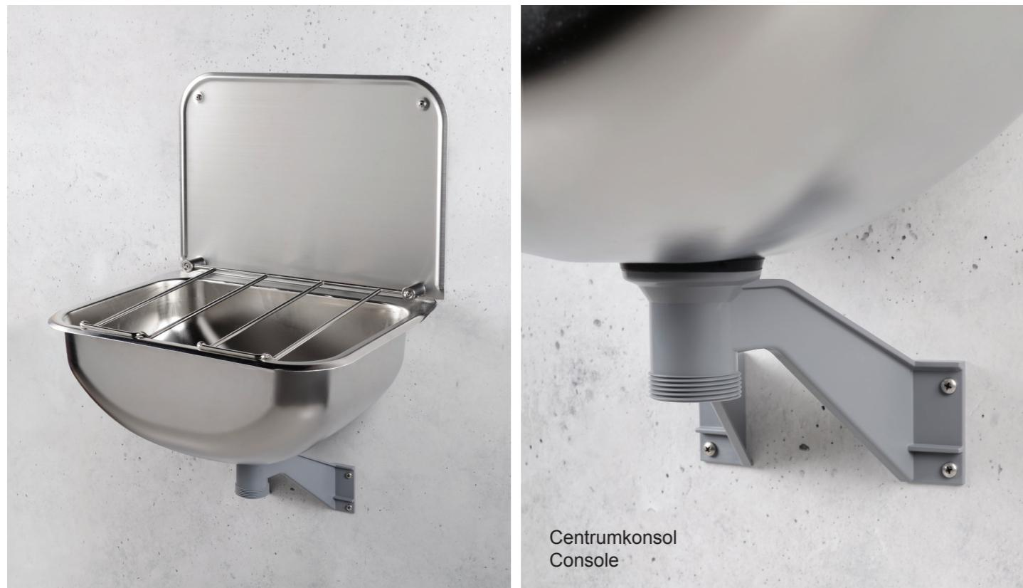
**JAFO Utslagsback med / utan bräddavlopp** är komplett med bottenventil G = 1 1/2", bräddavlopp, stänkplåt, galler samt centrumkonsol för upphängning. JAFO utslagsbackar är tillverkade i rostfritt stål SS 2333. Stabil upphängning då konsol och bottenventil integrerats. Nedan till höger visas lämpliga vattenlås ur JAFO:s sortiment.
