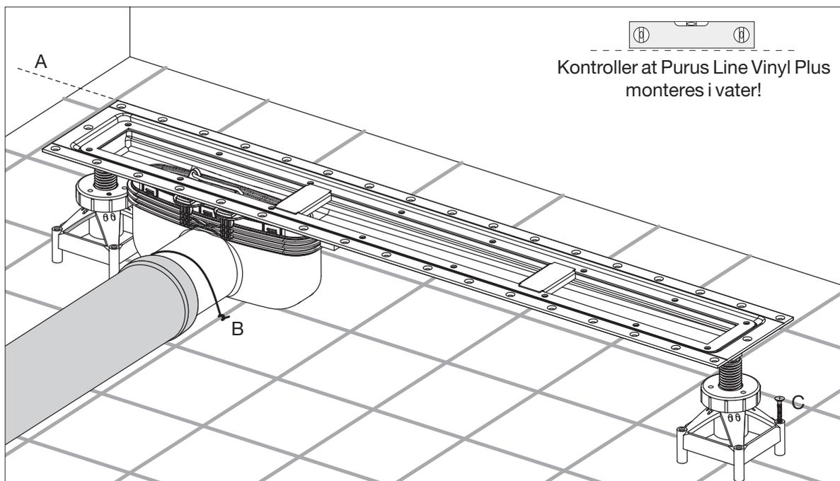
Purus Line Plus plasseres slik at overkanten flukter med det ferdig gulvet, dvs. på høyde med plastmatten (A).
