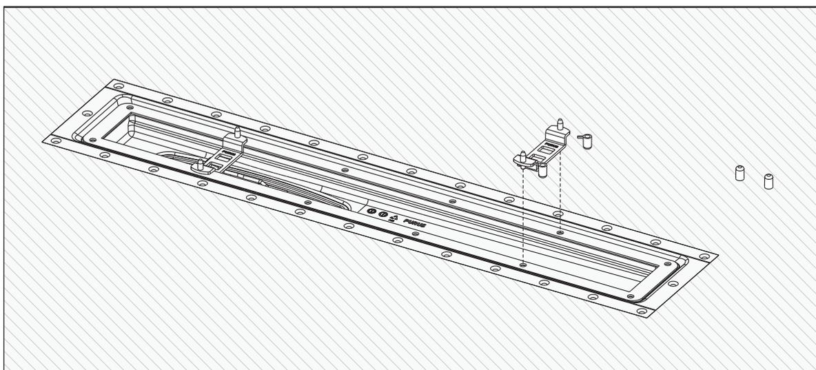
Vinylene monteres efter producentens anvisning. Skridsikker vinyl med struktur skæres plant omkring spændrammens sæde før montering. Bræk styrehylstrene af på de røde skæreskabeloner, gem styrehylstrene. Placer skæreskabelonen i hullerne. Sørg for, at skæreskabelonerne er placeret korrekt. (Se billedet ovenfor).
