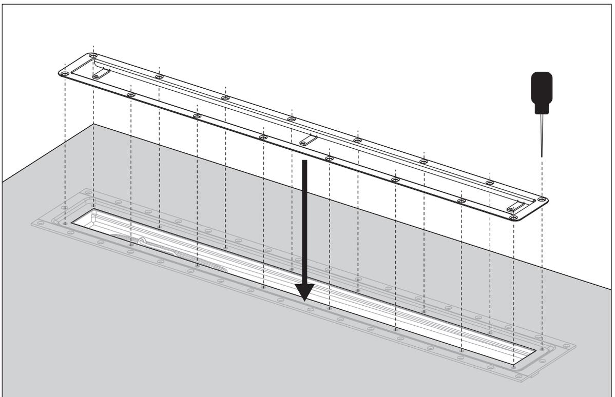
Lägg klämramen på plats och stick hål för skruvarna med t ex en syl. Se till att klämringens hål hamnar rakt ovanför skruvhålen i rännan.
