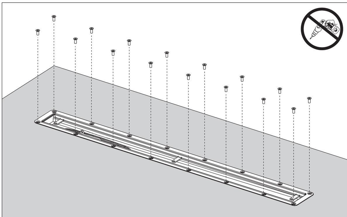
Återupphetta mattan vid behov. Fäst först skruvarna löst i varje skruvhål. Dra sedan fast skruvarna för hand i omgångar med början på klämramens mitten och utåt tills de bottnar i skruvhålen. Använd handverktyg!
