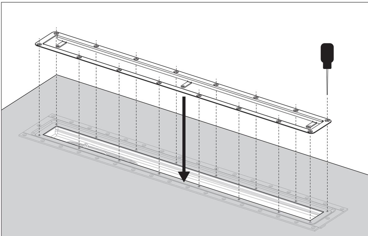
Legg klemrammen på plass og stikk hull til skruene med f.eks. en syl.
