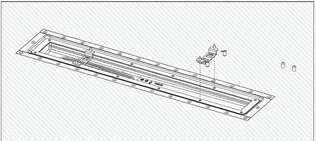
Plastmattan monteras enligt leverantörens anvisningar. Vid matta med nobbs skall dessa skäras av runt klämramens säte inför montering. Bryt av styrhysorna på de röda skärmallarna, spara styrhysorna. Placera skärmallarna i hållen närmast kortsidan av brunnen. Se till att skärmallen ligger på rätt håll (se bilden ovan).
