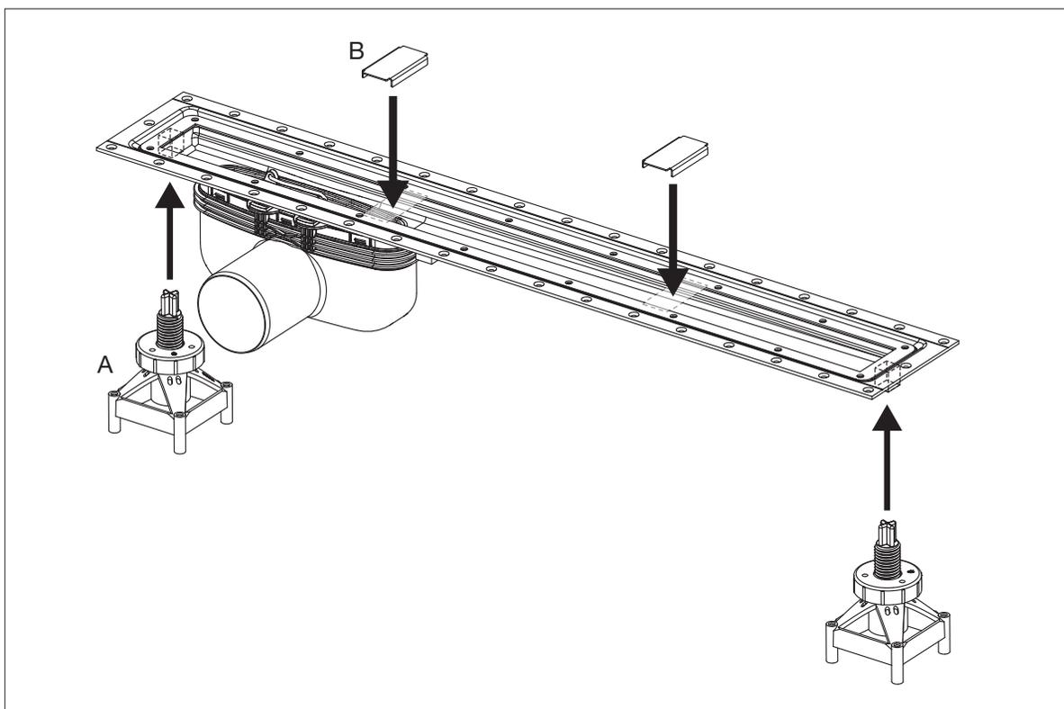
På undersiden af renden monteres støtteben i de forstøbte monteringshuller.
