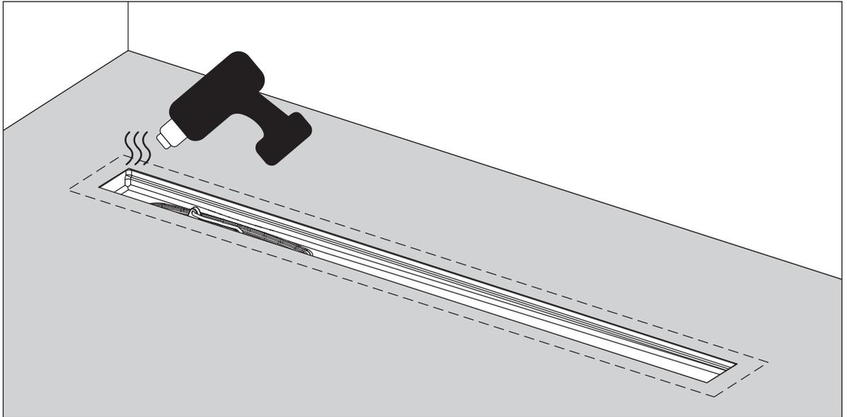
Opvarm vinylen, til den bliver blød. Kontrollér det med fingrene - men pas på, vinylen er meget varm!
