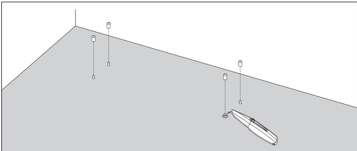
Legg ut vinylbelegget og trykk ned der skjæremalene er montert slik at tappene blir synlige gjennom belegget. Pass på at alle tappene er helt igjennom belegget og sett deretter på hylsene.
