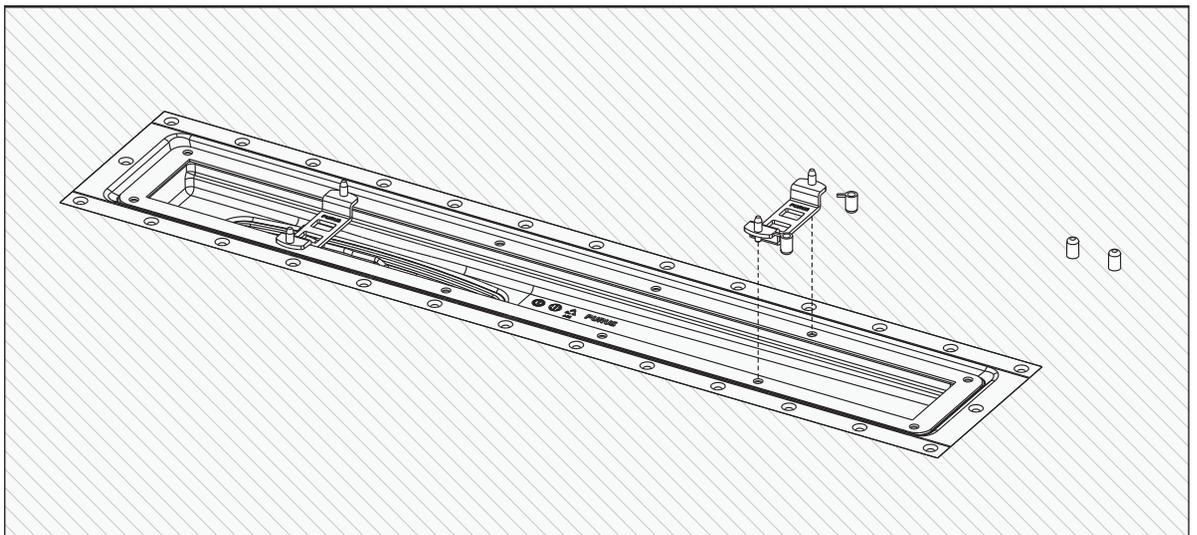
Muovimatto asennetaan mattoasennuksen ohjeiden mukaan. Taita ohjurihylsyt irti punaisista leikkuohjureista, säästä hylsyt. Aseta ohjuri lähimmäksi lyhyttä sivua oleviin reikiin. Varmista että ohjuri on oikein päin (ks. kuva).
