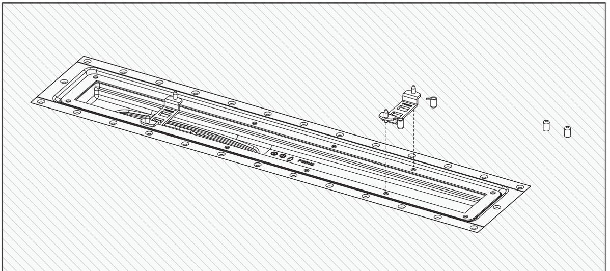
Muovimatto asennetaan mattoasennuksen ohjeiden mukaan. Taita ohjurihylsyt irti punaisista leikkuuohjureista, säästä hylsyt. Aseta ohjuri lähimmäksi lyhyttä sivua oleviin reikiin. Varmista että ohjuri on oikein päin (ks. kuva).
