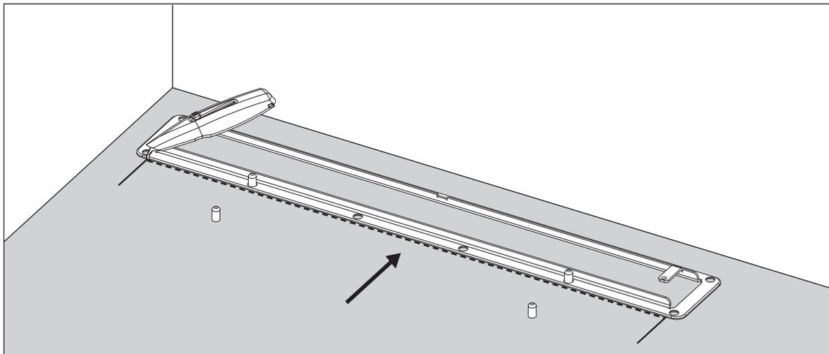
Flytta ramen och lägg endast på två av styrhysorna för att skära längs med långsidans ytterkant som en linjal.
