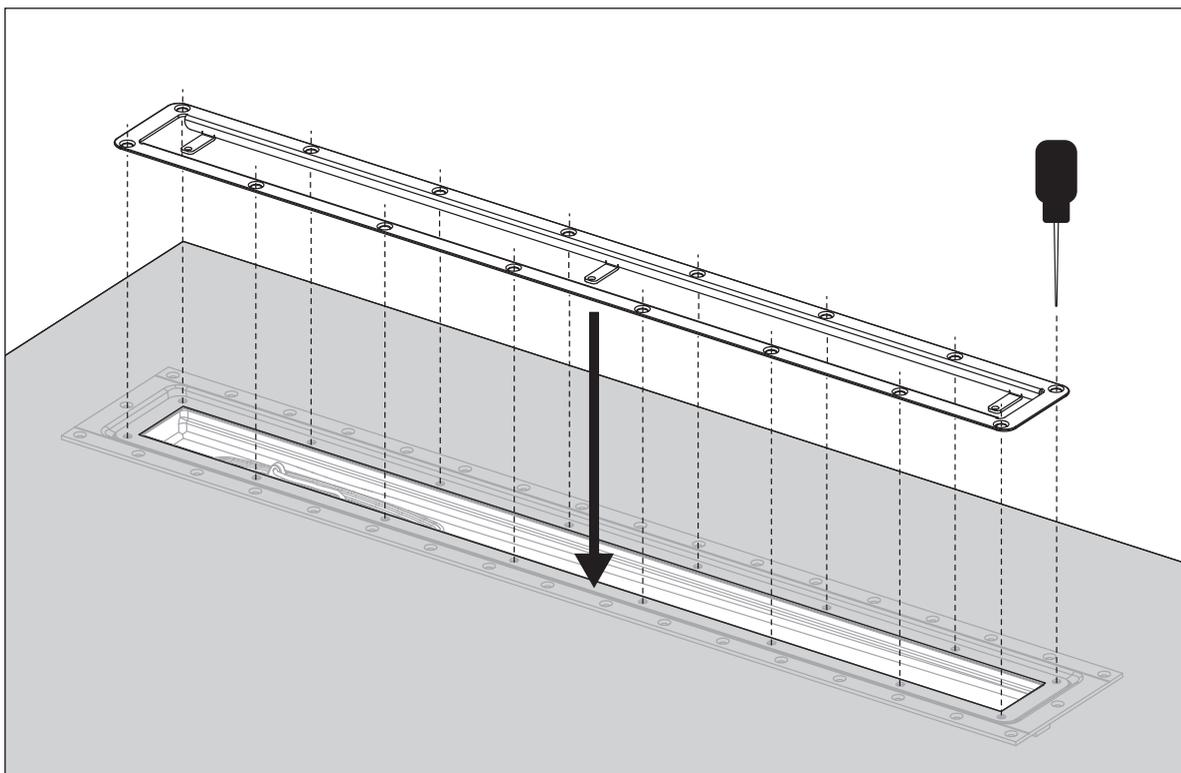
Lägg klämramen på plats och stick hål för skruvarna med t ex en syl. Se till att klämringens hål hamnar rakt ovanför skruvhålen i rännan.
