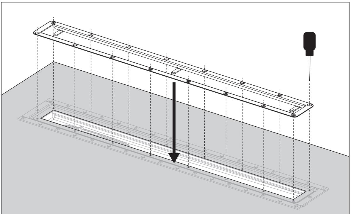
Læg klemrammen på plads, og prik huller i vinylen til skruerne f.eks. med en syl. Vær opmærksom på, at hullerne i vinylen er lige over skruehullerne i renden.
