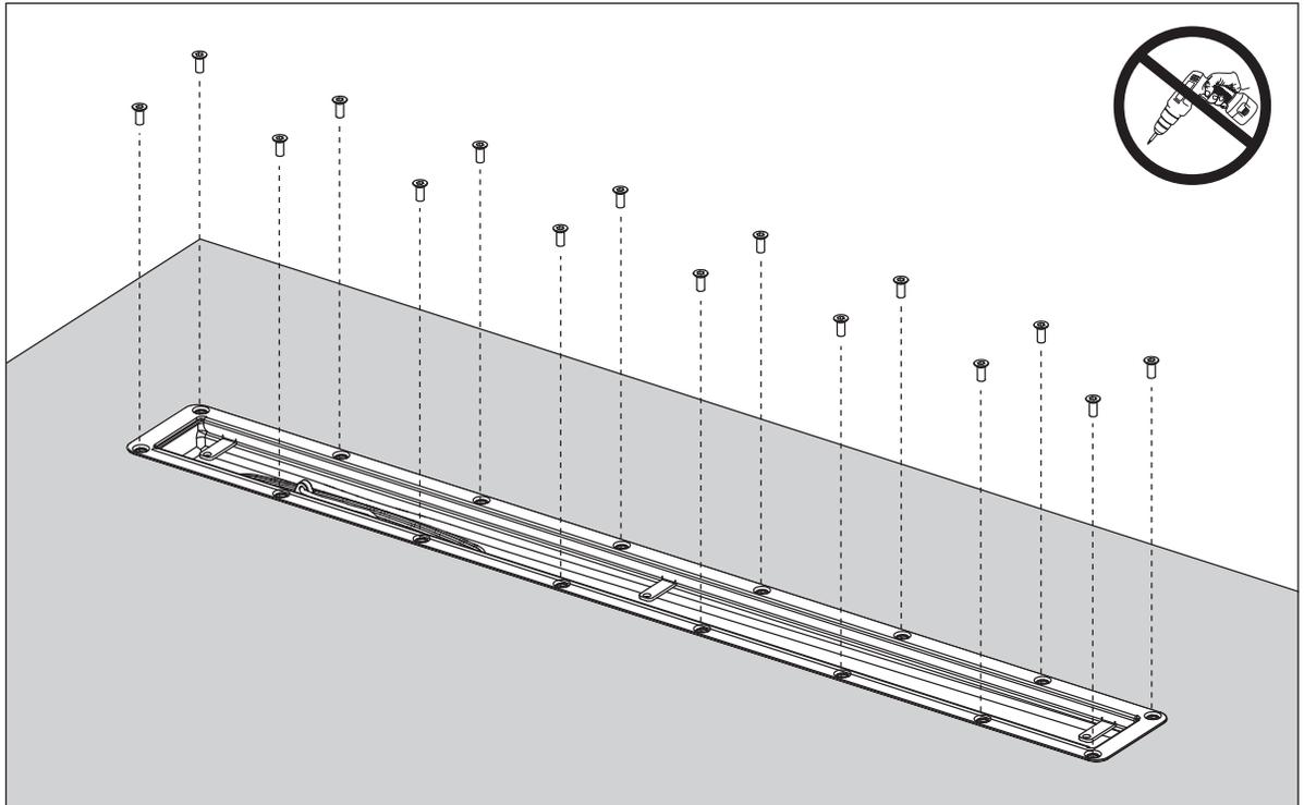
Återupphetta mattan vid behov. Fäst först skruvarna löst i varje skruvhål. Dra sedan fast skruvarna för hand i omgångar med början på klämramens mitten och utåt tills de bottnar i skruvhålen. Använd handverktyg!
