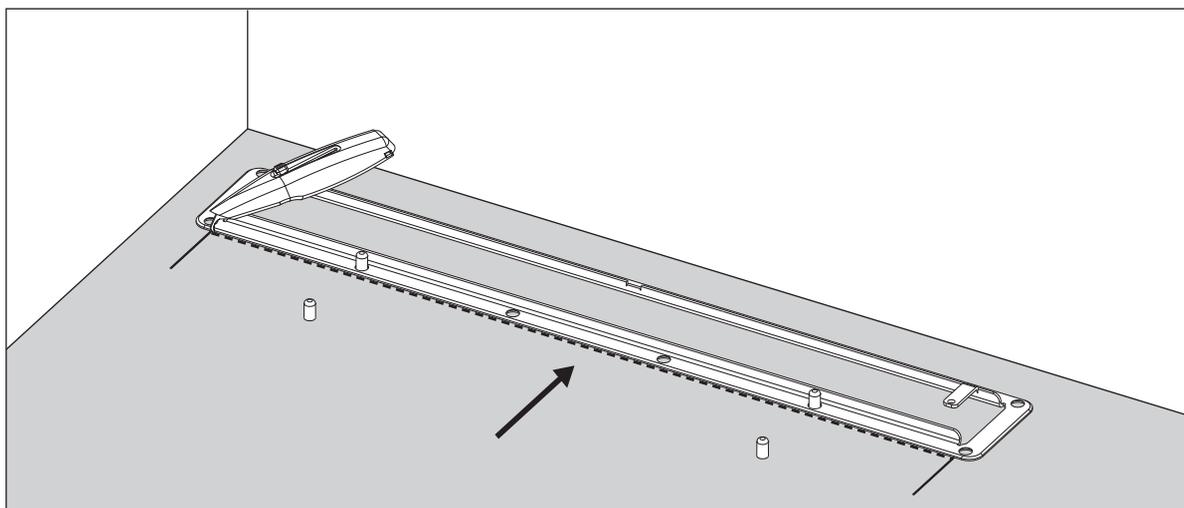
Flytta ramen och lägg endast på två av styrhyslorna för att skära längs med långsidans ytterkant som en linjal.
