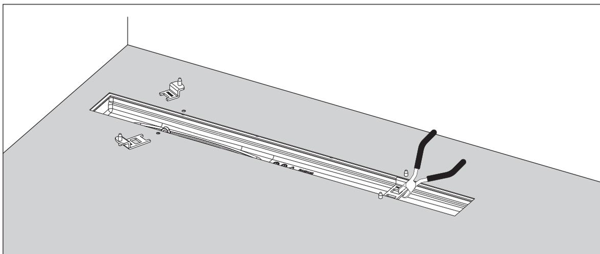
Ta bort klemrammen, fjern hylsene og ta deretter bort det utskjærte feltet av vinylbelegget. Klipp deretter skjæremalene i to deler og fjern dem fra rennen.
