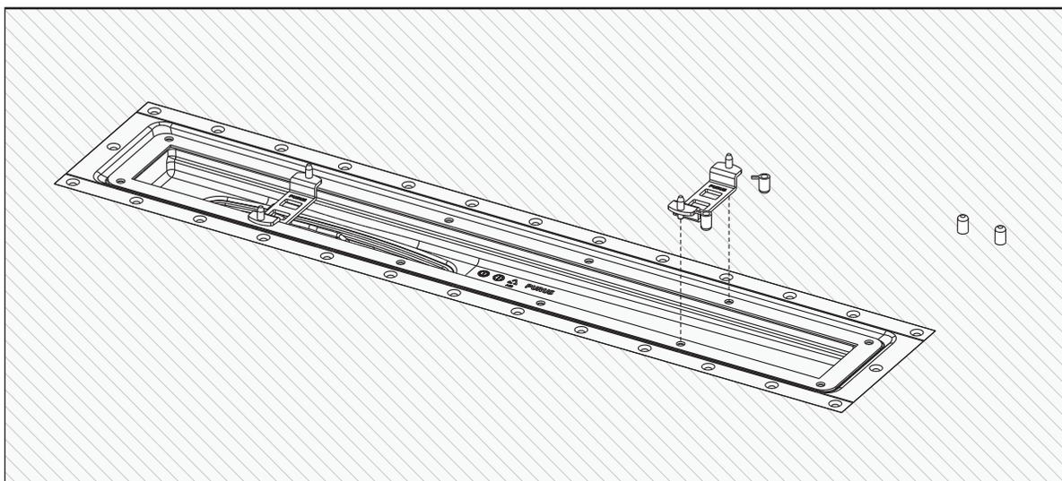
Vinylen monteres efter producentens anvisning. Skridsikker vinyl med struktur skæres plant omkring spændrammens sæde før montering. Bræk styrehylstrene af på de røde skæreskabeloner, gem styrehylstrene. Placer skæreskabelonen i hullerne. Sørg for, at skæreskabelonerne er placeret korrekt. (Se billedet ovenfor).
