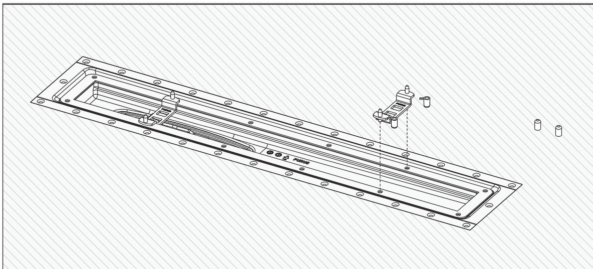
Plastmattan monteras enligt leverantörens anvisningar. Vid matta med nobbs skall dessa skäras av runt klämramens säte inför montering. Bryt av styrhylsorna på de röda skärmallarna, spara styrhylsorna. Placera skärmallarna i hållen närmast kortsidan av brunnen. Se till att skärmallen ligger på rätt håll (se bilden ovan).
