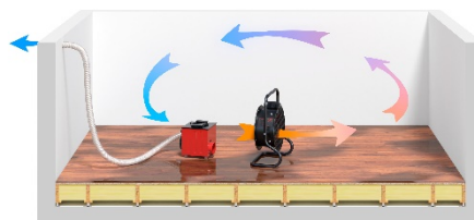
Märkäilma on aina johdettava letkun kautta pois kuivattavasta tilasta. Kuvassa näytetään huonekuivaus.
