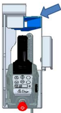
Ultraljudssensor på plattformskontrollens fäste
