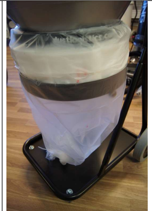
7. Longopac paikalleen asennettuna. Kuvan mukaisesti Longopacin vapaa yläreuna voidaan kääntää siististi aiemmin asennetun kiristyremmin päälle.
