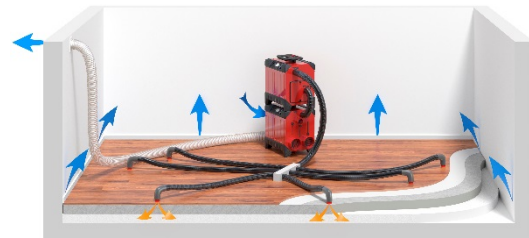
Painekuivaus. Turbiini imee kuivaa ilmaa kuivaimesta ja puhalttaa sen kerrosrakenteeseen.
