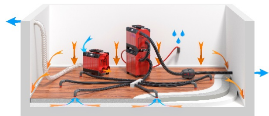
Imukuivaus. Kuivain kuivaa huoneilman ja turbiini imee ilmaa kerrosrakenteesta, jolloin kuivaa ilmaa imetään sen läpi.
