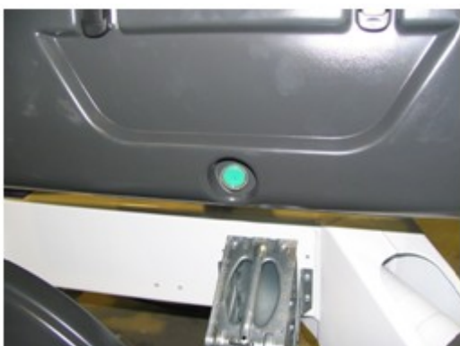
10.2 Startknapp for motoren ved støttebein
