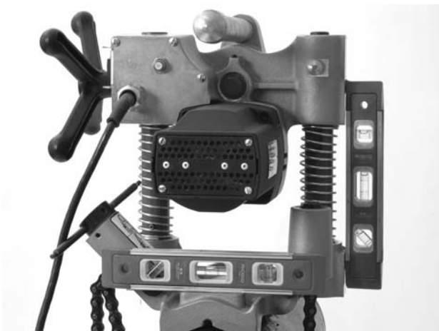
Figura 10 – Nivelación de la HC-300
