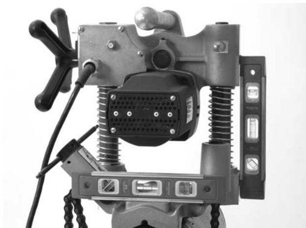
Figure 10 – Mise de niveau de la HC-300
