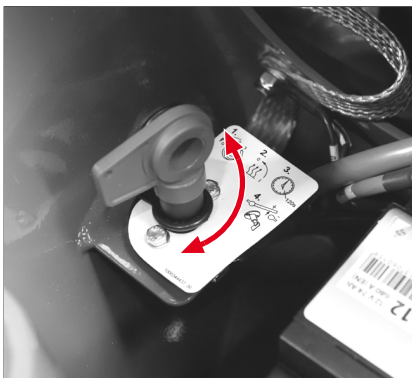
Kuva 94: Akun virtakatkaisimen sijainti
