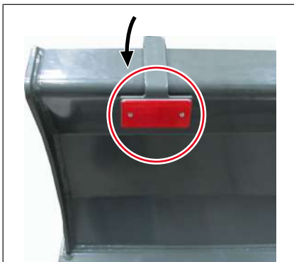
Bild. 172: Reflektor på schaktbladet bak
