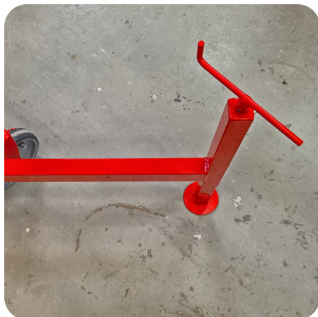
TUKIJALAT MAHDOLLISTAA ULKOKÄYTÖN EN 280/2013 12.5 M/S TUULI
