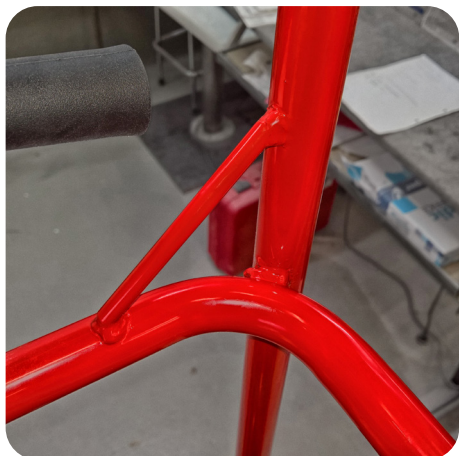
TURVAVALJAIDEN KIINNITYSPAIKAT EN 280/2013 3kN VOIMA
