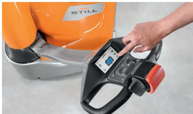
Överblick hela tiden: En pekskärm som tillval med en rad språkoberoende symboler visar alla viktiga funktioner på ett ögonblick
