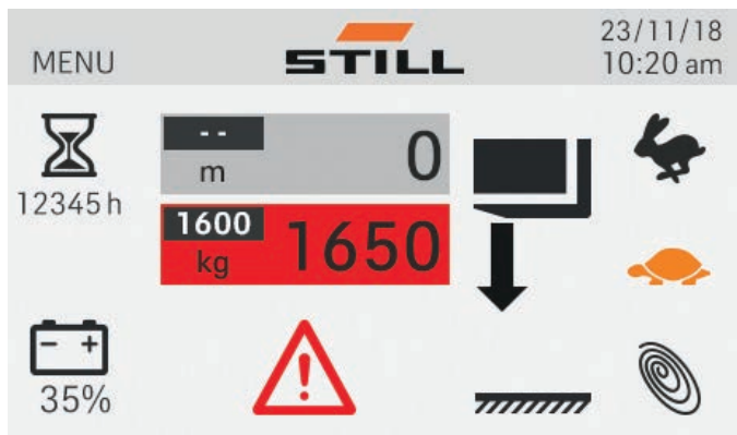
Säker förvaring och hämtning tack vare Dynamic Load Control, varningssystemet för restlastkapacitet
