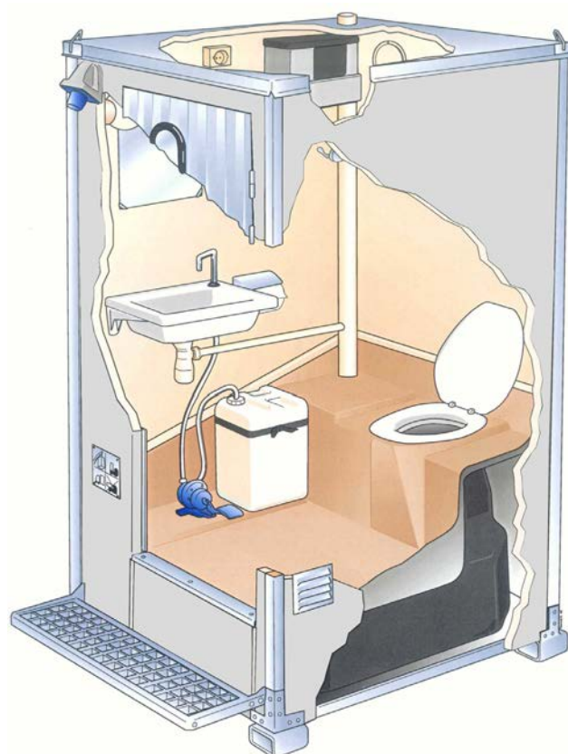
Genomskärning av en Toalett-kabin med latrintank.
