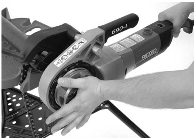
Figura 13 – Inicio del roscado
