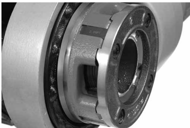
Slika 15 – Cev je poravnana z robom rezalnih nastavkov
