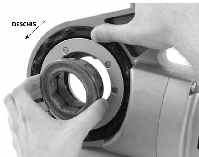
Figura 8 – Montarea adaptorului în 690-I
