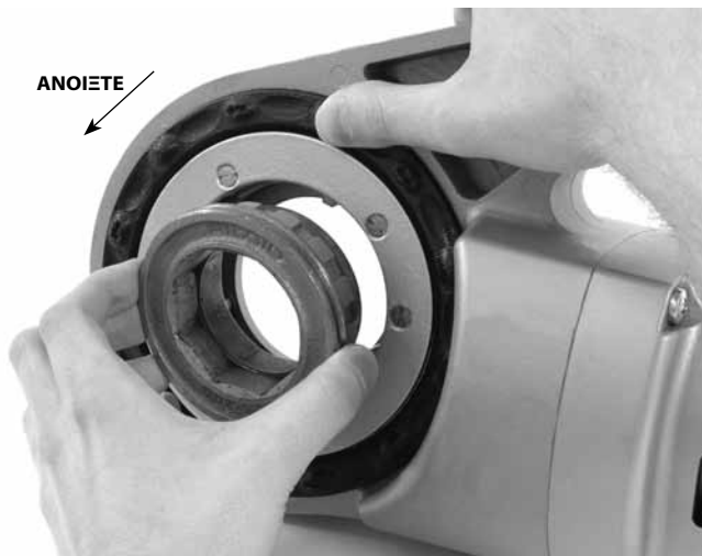
Εικόνα 8 – Τοποθέτηση προσαρμογέα στο 690-I
