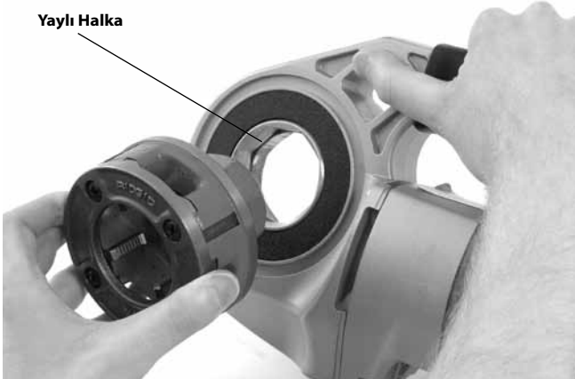
Şekil 9 - Pafta Kafalarının 600-I Elektrikli El Paftasına Takılması
