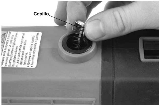
Figura 18 – Colocación del cepillo
