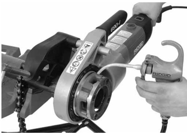
Figur 14 – Gevindskæring af rør
