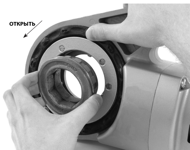
Рис. 8 – Установка переходника в силовой привод 690-I
