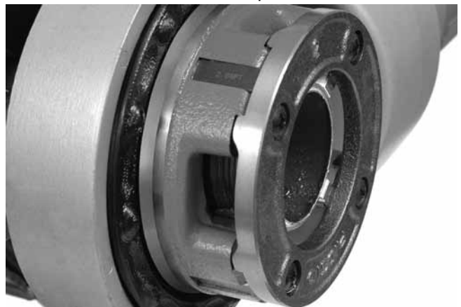
Abbildung 15 - Rohr mit Schneidbackenkante bündig
