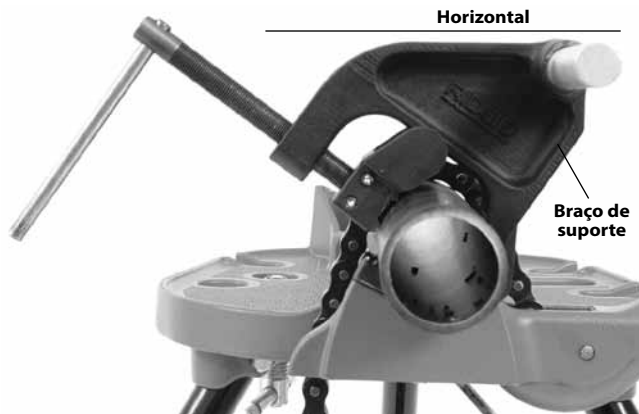
Figura 11A – Posicionar o Braço de Suporte
