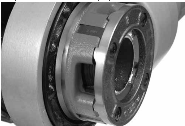
Slika 15 – Cijev poravnata s rubom noževa
