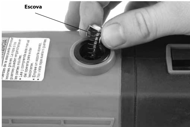
Figura 18 – Instalação da Escova
