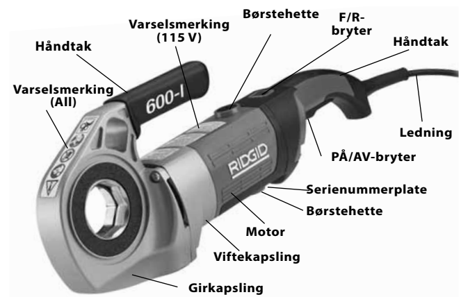
Figur 1 – modell 600-I håndgjengemaskin
