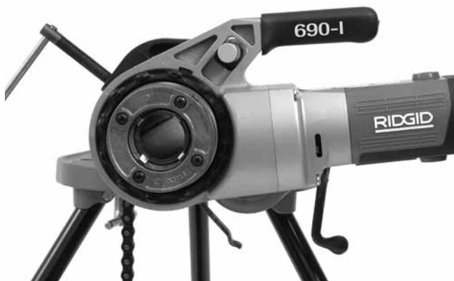
Obrázek 12 – správná orientace elektrické závitnice
