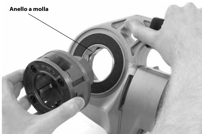
Figura 9 – Installazione delle Teste portapettini nel Filettatrice 600-I
