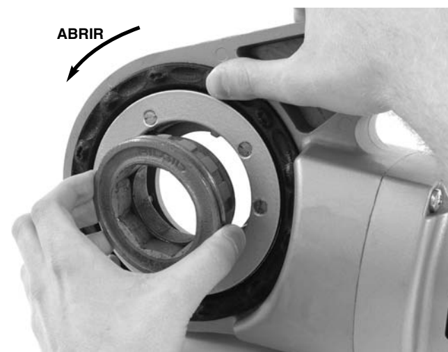
Figura 8 – Montaje del adaptador en la máquina 690-I
