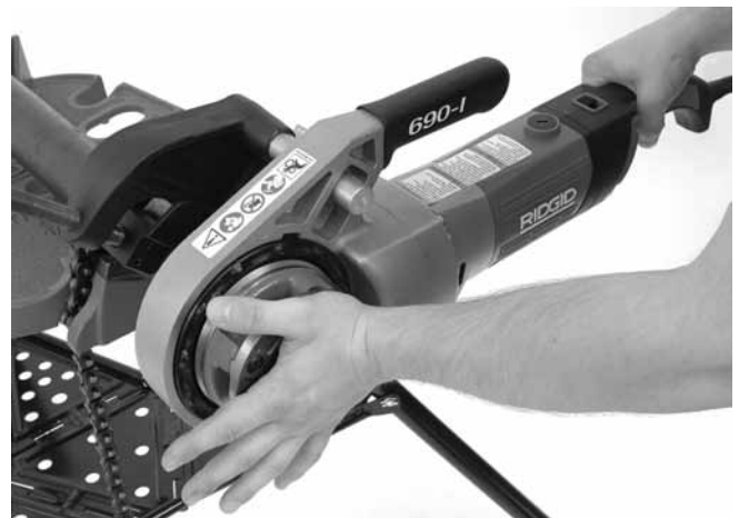
Obrázek 13 – začátek řezání závitů
