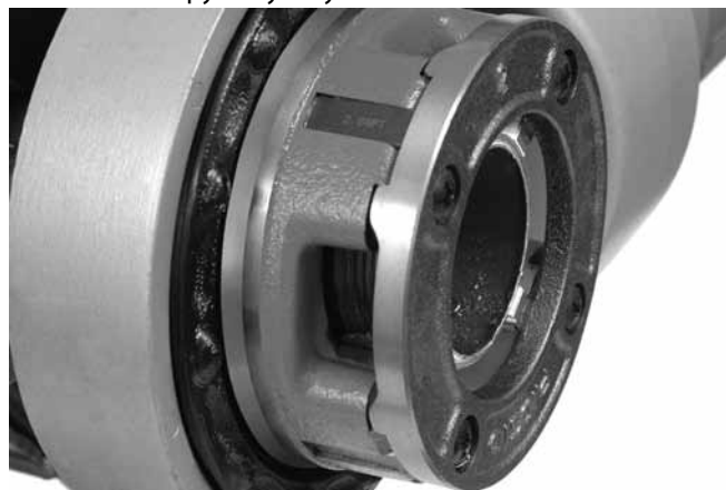
Kuva 15 – Putki terien reunan tasalla
