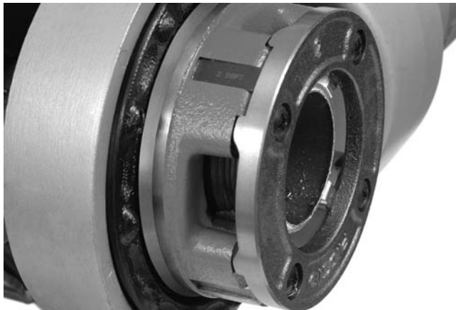
Figure 15 – Tuyau arrivé à fleur des filières
