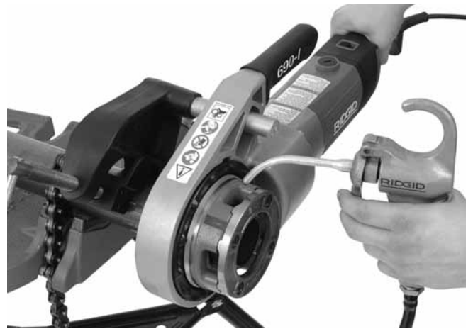
Şekil 14 - Boruya Diş Açılması
