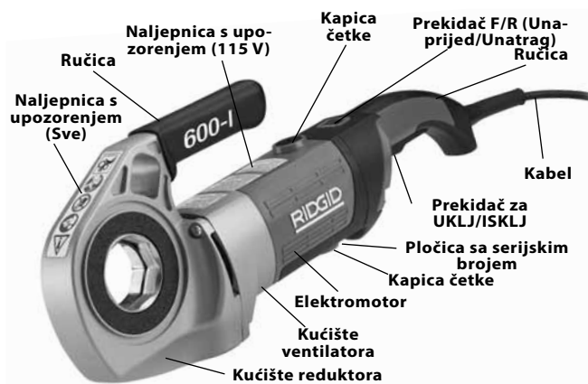
Slika 1 – Alat model 600-I
