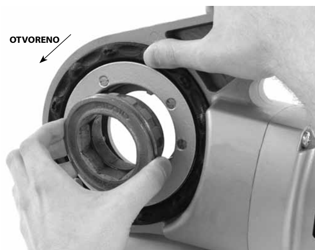
Slika 8 – Stavljanje adaptera u 690-I
