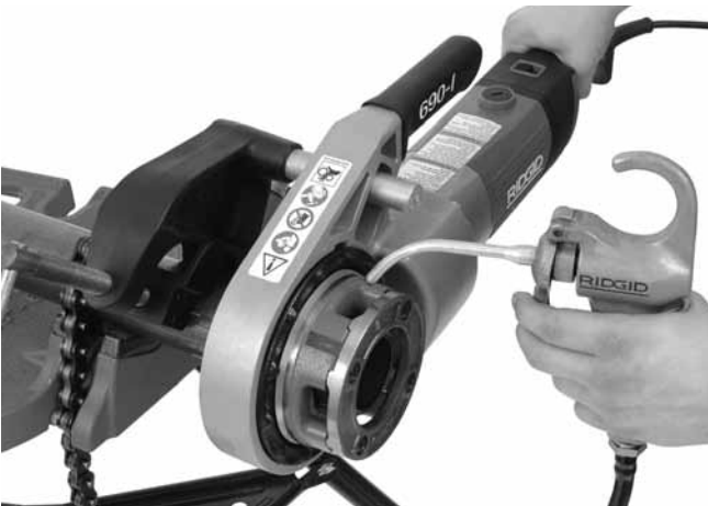
Figura 14 – Filettatura del tubo
