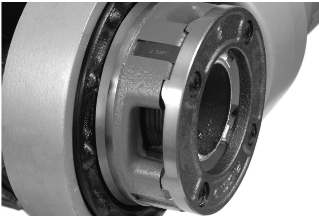
Рис. 15 – Торец трубы вровень с кромкой резьбонарезных гребенок
