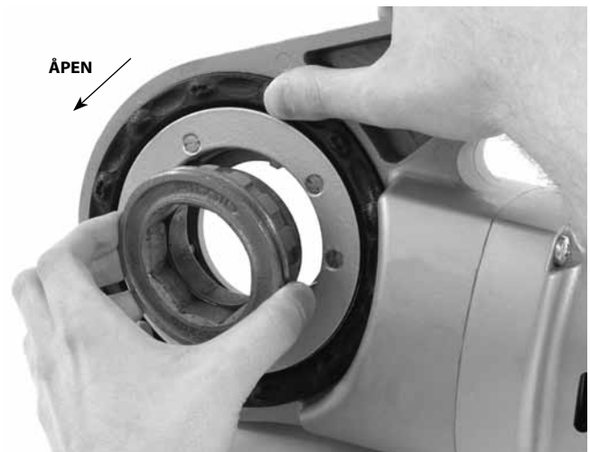
Figur 8 – installere adapter i 690-I
