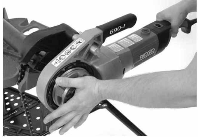
Şekil 13 - Diş Açmaya Başlama
