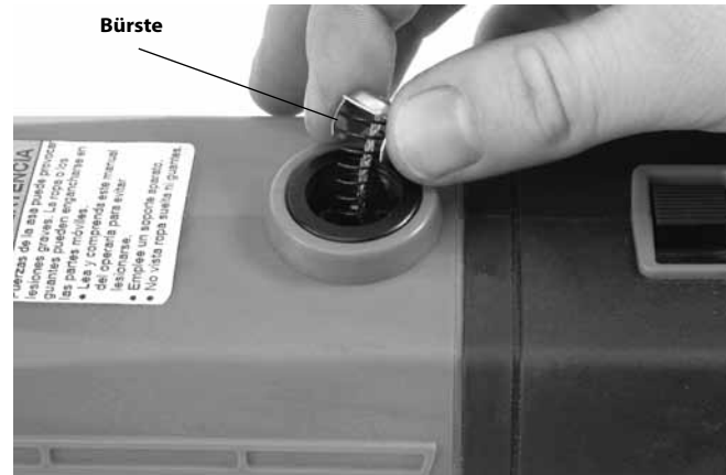
Abbildung 18 - Einbau der Bürsten
