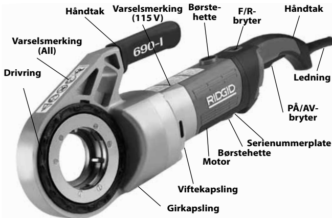
Figur 2 – modell 690-I håndgjengemaskin
