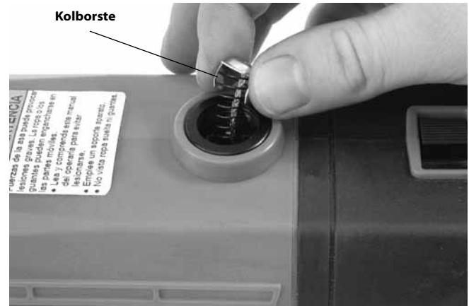
Figur 18 – Montering av kolborstar
