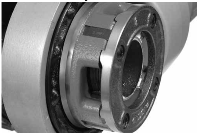
Figur 15 – Röret i linje med gängbackarnas kant
