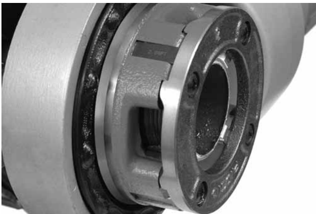
Figura 15 – Țeava la nivel cu marginea filierelor
