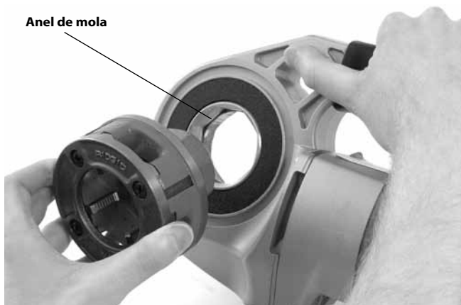
Figura 9 – Instalar Cabeças de rosca no Propulsor 600-I
