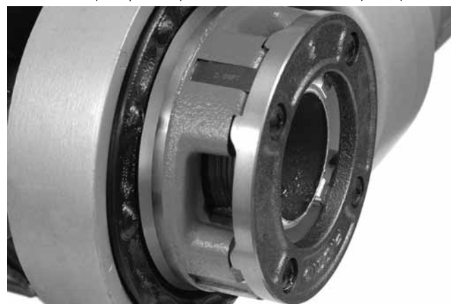
15-сурет – Құбыр кескіш жиектерімен бір деңгейде
