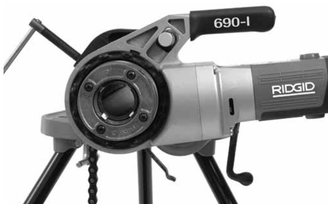
Figuur 12 – Correcte stand van de aandrijfmachine
