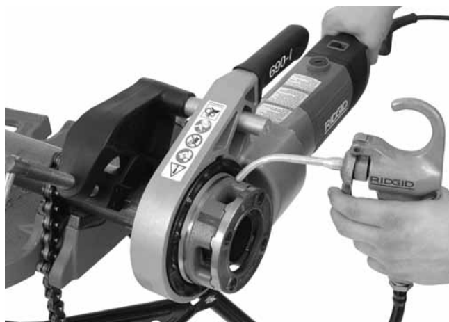
14. ábra – Menetvágás csőre
