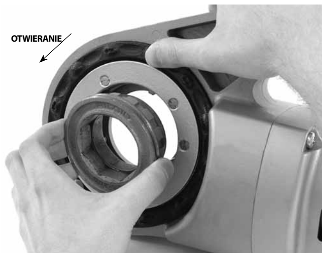
Rys. 8 – Montaż adaptera na modelu 690-I
