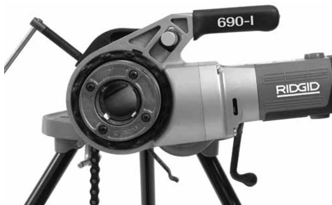
Slika 12 – Pravilna orientacija električnega pogona
