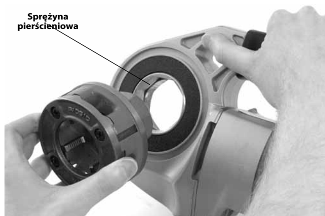
Rys. 9 – Montaż głowic gwinciarских na napęd elektryczny 600-I
