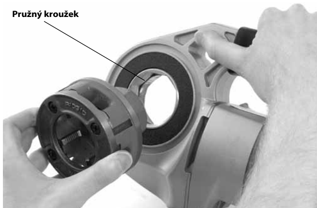
Obrázek 9 – instalace závitorezných hlav do elektrické závitnice 600-I
