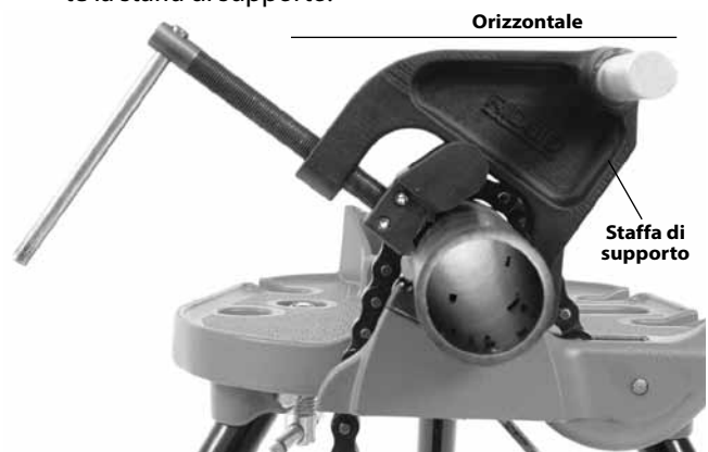
Figura 11A – Posizionamento della Staffa di supporto
