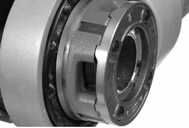
Şekil 15 - Paftanın Kenarıyla Hizalı Boru
