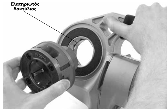
Εικόνα 9 – Τοποθέτηση φιλιέρων στον ηλεκτρικό βιδολόγο 600-I
