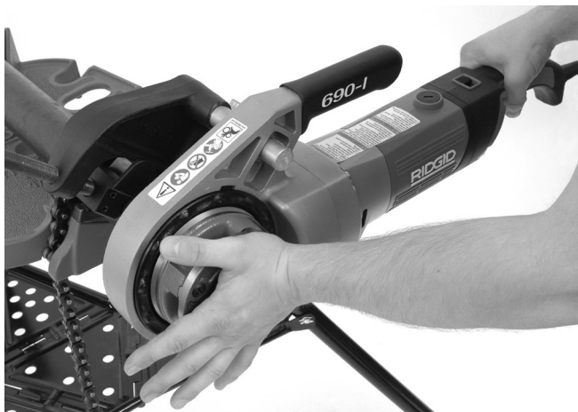
Рис. 13 – Начало нарезания резьбы
