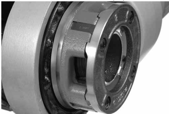
Slika 15 – Cev poravnata sa ivicom nareznice
