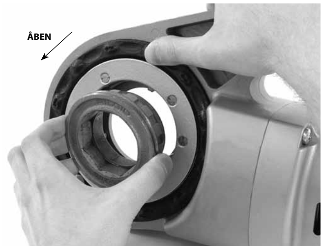
Figur 8 – Montering af adapter i 690-I
