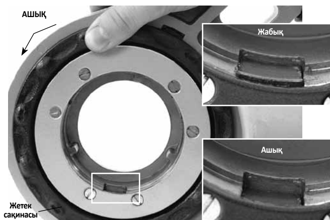
7-сурет – Стопор механизмi, Ашық/Жабық позициядағы жетек сақинасы
