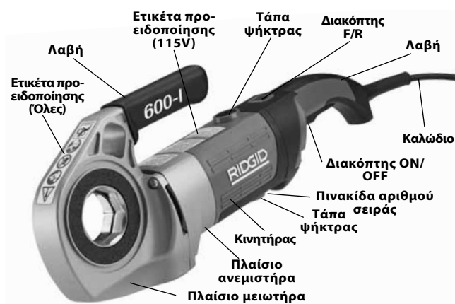
Εικόνα 1 – Μοντέλο 600-I ηλεκτρικού βιδολόγου
