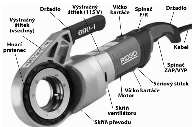
Obrázek 2 – elektrická závitnice model 690-I
