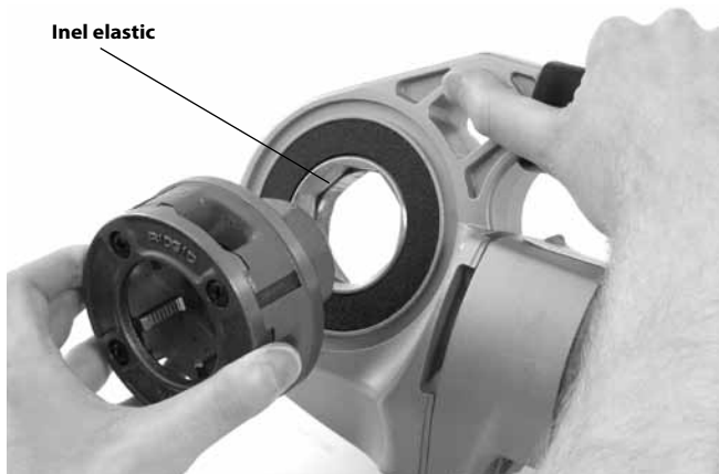
Figura 9 – Montarea capetelor filieră în clupa electrică 600-I
