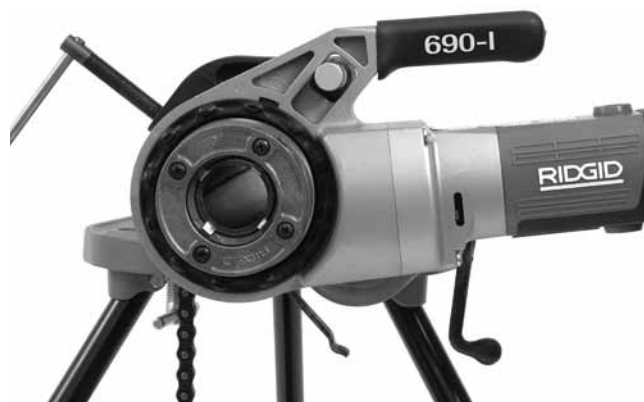
Figur 12 – Drivenhetens korrekta orientering
