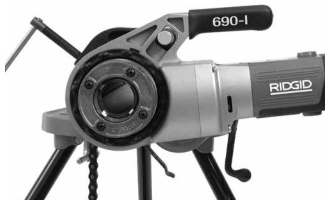
Εικόνα 12 – Σωστός προσανατολισμός του ηλεκτρικού βιδολόγου
