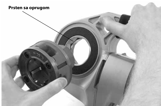
Slika 9 – Stavljanje narezne glave u električnu nareznicu 600-I
