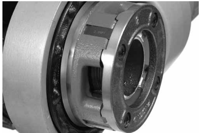
Figuur 15 – Pijp gelijk met rand van snijkussens
