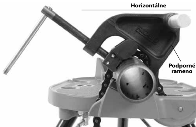
Obrázok 11A – Umiestnenie podporného ramena
