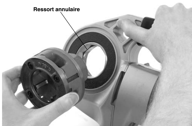
Figure 9 – Installation des têtes de filière sur le système d'entraînement 600-I
