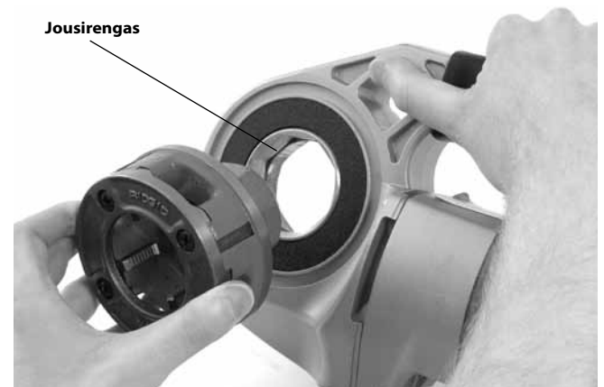
Kuva 9 – Kierrepäiden asennus 600-I-käyttölaitteeseen
