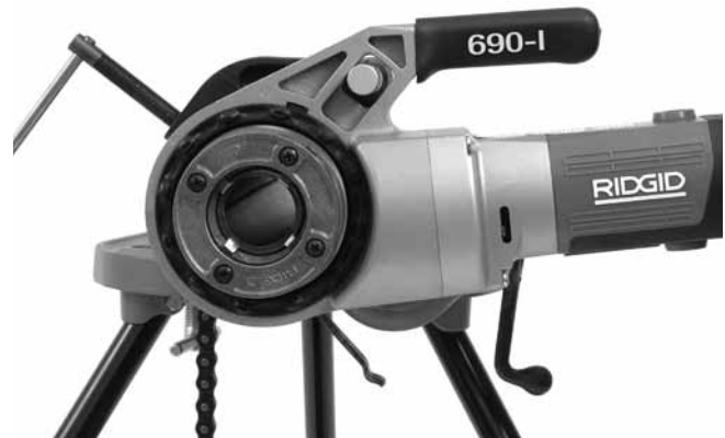
Şekil 12 - Elektrikli El Paftasının Doğru Yönü
