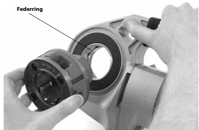
Abbildung 9 - Einbau von Schneidköpfen in die 600-I Gewindeschneidmaschine
