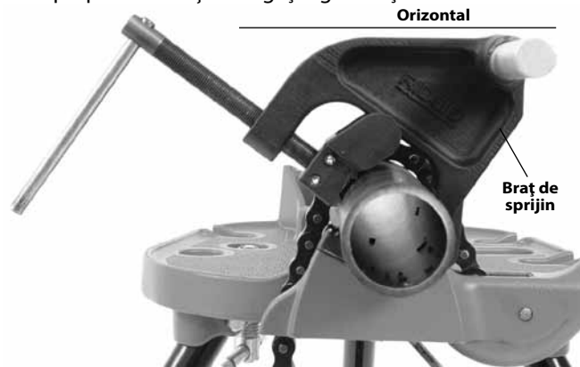
Figura 11A – Poziționare braț reazem
