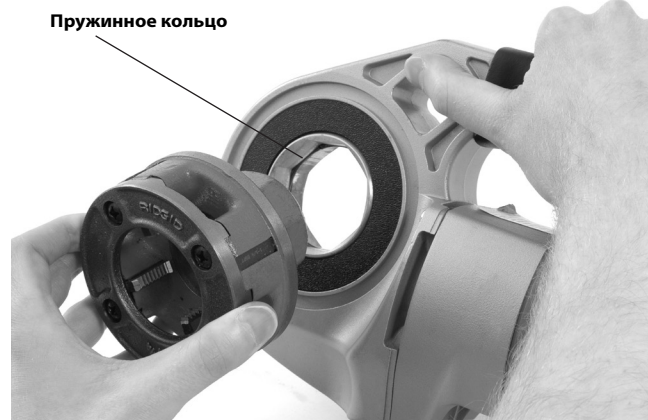
Рис. 9 – Установка резьбонарезных головок в силовой привод 600-I
