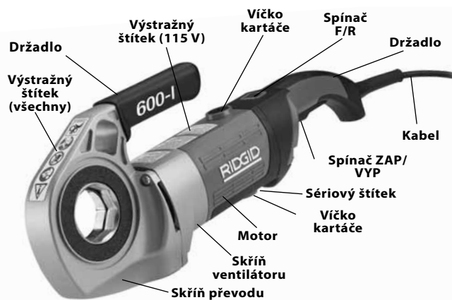
Obrázek 1 – elektrická závitnice model 600-I
