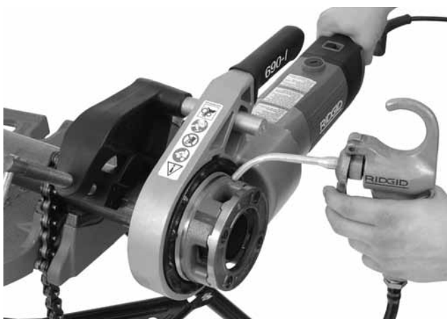
Obrázek 14 – řezání závitu na trubce
