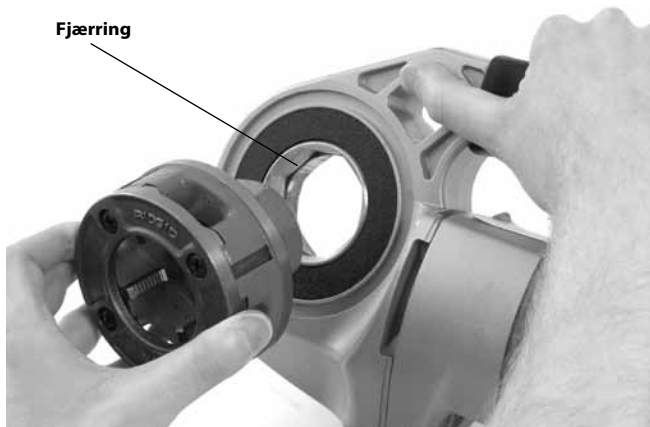
Figur 9 – installere gjengeskjærehoder i 600-I håndgjengemaskin
