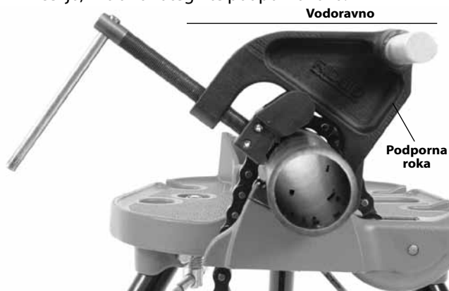
Slika 11A – Določanje položaja podporne roke
