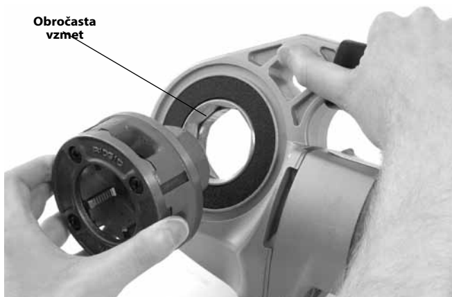
Slika 9 – Vgradnja rezalnih glav v električni pogon 600-I
