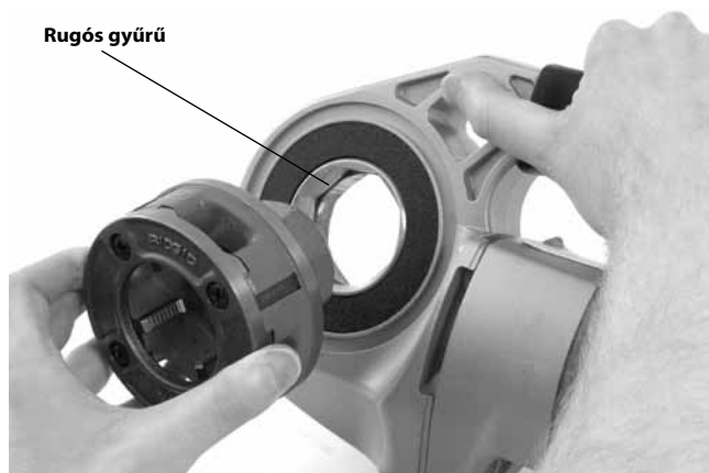
9. ábra – Menetvágó fejek beszerelése a 600-I motoros hajtóegységbe
