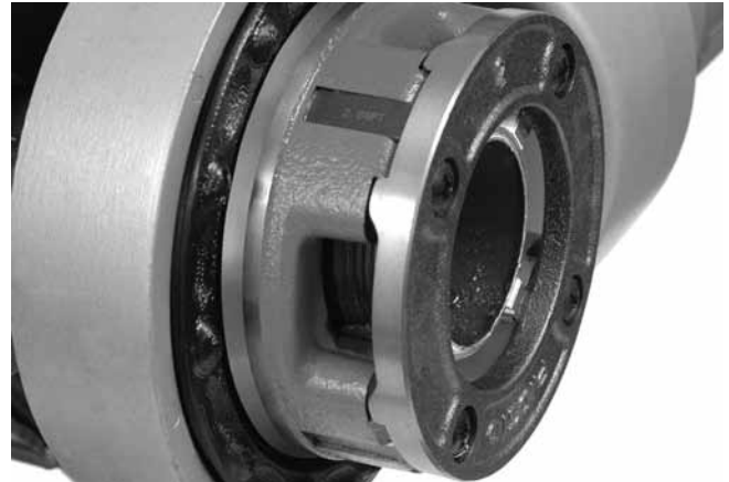
Figura 15 – Tubo allineato rispetto al margine dei pettini
