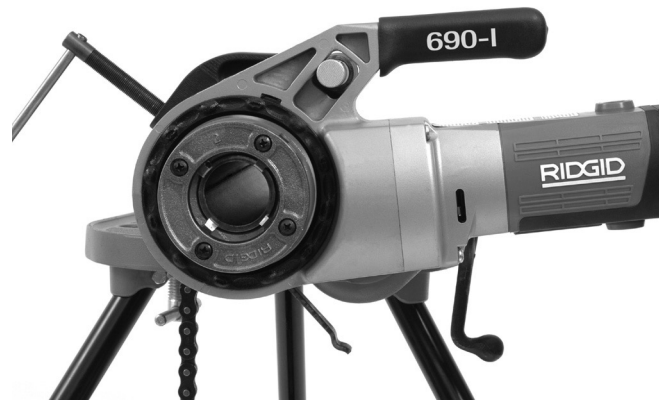
Рис. 12 – Правильное расположение силового привода
