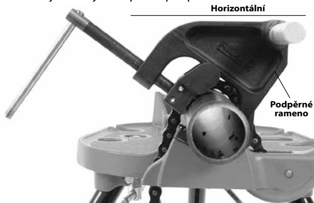
Obrázek 11A – umístění podpěrného ramene
