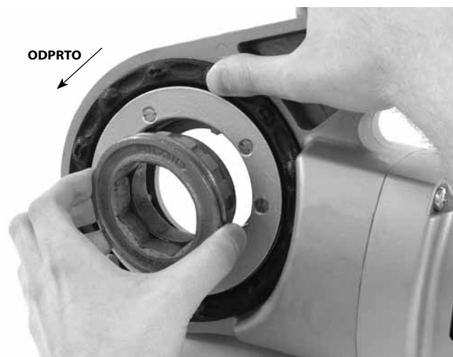
Slika 8 – Vstavljanje prilagodilnika v 690-I
