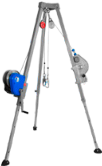
IKAR trefod type DB-A2 med IKAR PLW og HRA 18 inklusive udvekslingsruller og karabinhager
