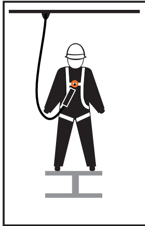
Treuil de levage de personnes et de charges (PLW) - Point d'attache pectoral
