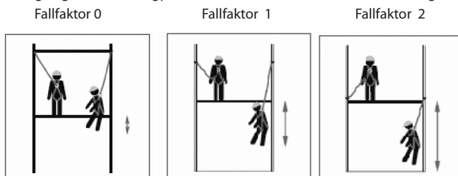
Abbildung 2: Vergleich der Fallfaktoren vor und nach einem Absturz
