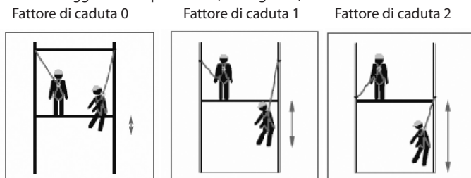
Figura 2: confronto dei fattori di caduta prima e dopo una caduta.
