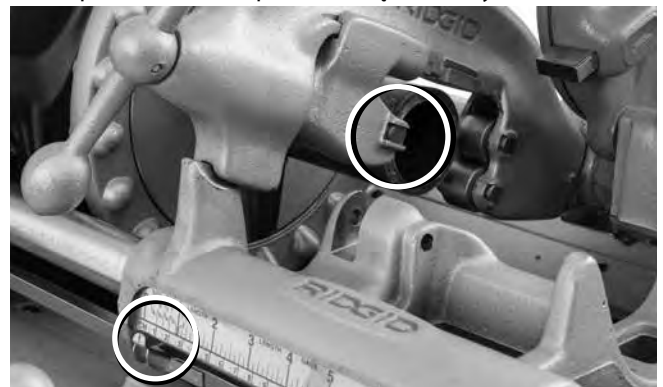
Rysunek 20A – Ostrze krążka obcinaka na końcu rury. Ustawić wskaźnik na zero (0)
