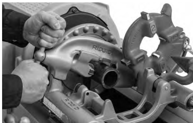
Рис. 21 – Резка трубы с помощью трубореза
