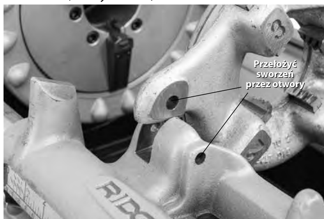
Rysunek 26 – Unieruchamianie głowicy gwinciarskiej lewozwojnej
