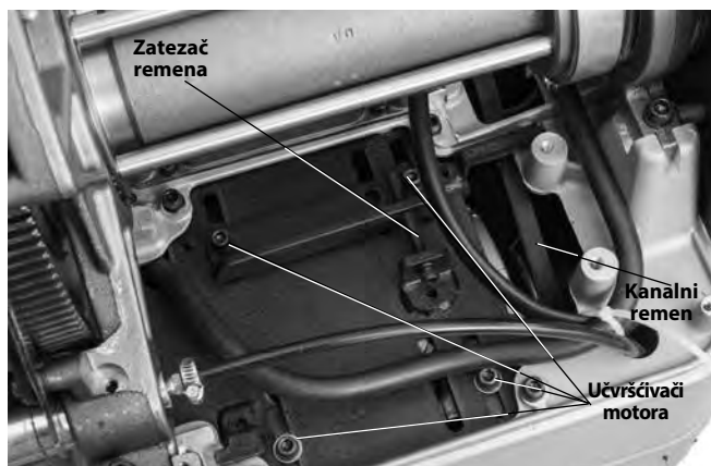
Slika 35 - Zatezanje remena
