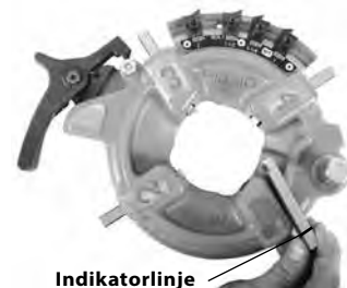
Figur 14 – Isætning af bakker
