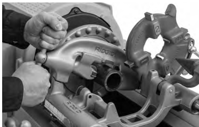
Figur 21 – Kutte rør med kutter
