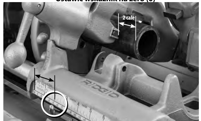
Rysunek 20B – Wskaźnik sprawdzianu długości na żądanej długości
