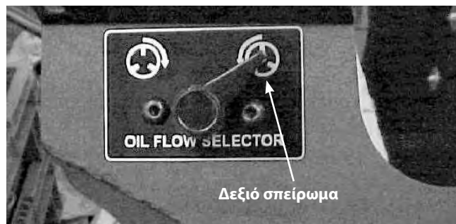
Εικόνα 24 – Αριστερός ή δεξιός επιλογέας ροής λαδιού
