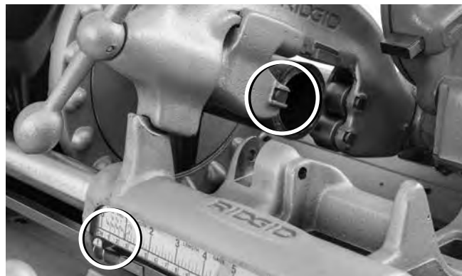
20А-сурет – Құбыр шетіне қарсы кескіш дөңгелегінің жүзі. Нұсқағышты нөлге (0) орнатыңыз
