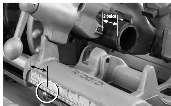
Obrázok 20B – Ukazovateľ meradla dĺžky na požadovanej dĺžke
