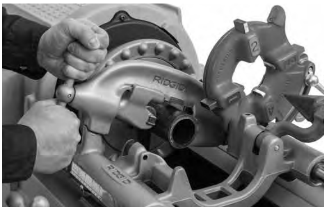
Rysunek 21 – Cięcie rury za pomocą obcinaka
