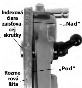
Obrázok 11 – Úprava veľkosti závitú
