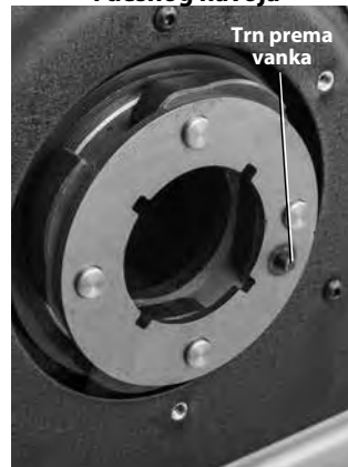
Slika 25B - Podrška stražnje okretne šipke - zamjena trna
