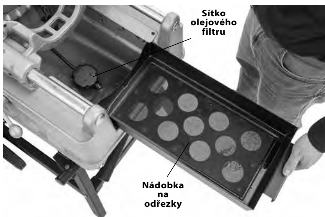
Obrázek 30 – Odstranění nádoby na odřezky
