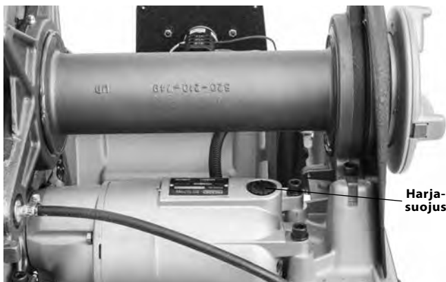
Kuva 34 – Moottorin kannen irrotus / harjojen vaihto
