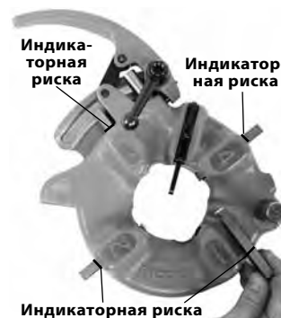
Рис. 10 – Установка резьбонарезных гребенок
