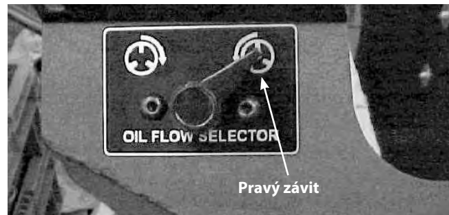
Obrázok 24 – Volič ľavého alebo pravého prúdenia oleja
