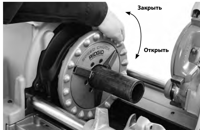
Рис. 16 – Закрепление трубы в зажимном патроне
