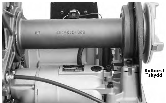
Figur 34 – Byte av motorkåpa/kolborstar
