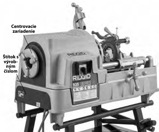
Obrázok 1B – Závítorez 535 s manuálnym skľučovadlom
