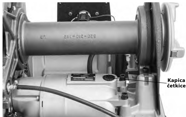
Slika 34 - Skidanje poklopca motora/zamjena četkica
