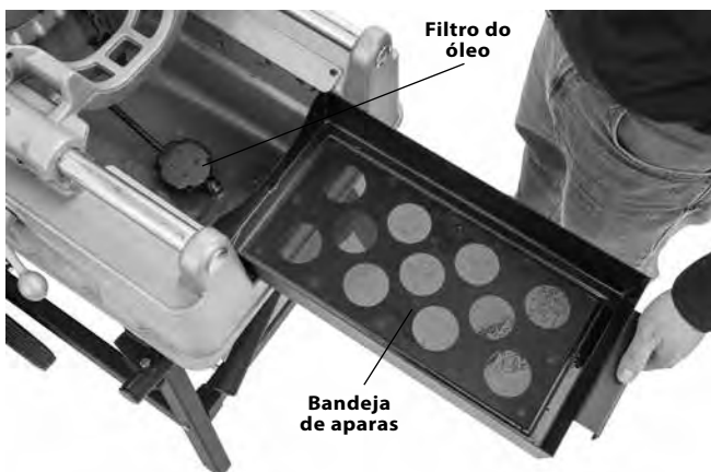
Figura 30 – Remover a bandeja de aparas
