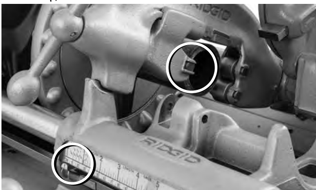
Εικόνα 20A – Λεπίδα μαχαιριών κόφτη στο άκρο του σωλήνα. Ρυθμίστε τον δείκτη στο μηδέν (0)
