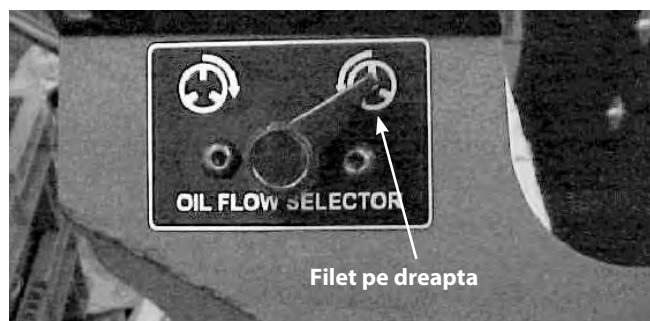
Figura 24 – Selector debit ulei LH sau RH (la stânga sau la dreapta)
