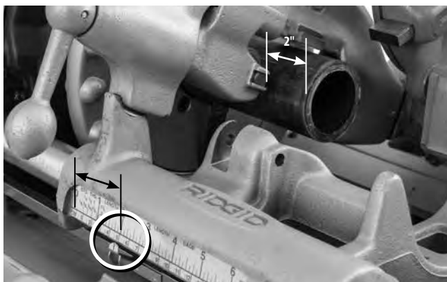
Figur 20B – Længdemålermarkør ved ønsket længde
