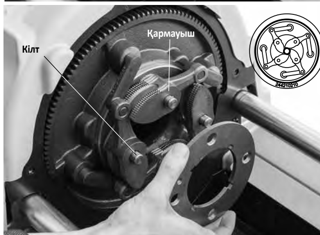
32-сурет – Автоматты патронмен құрылғы қармауыштарын ауыстыру
