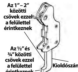
12. Ábra – A kioldószán beállítása
