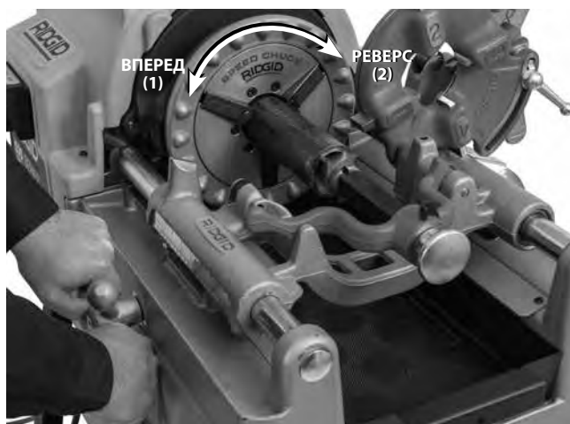
Рис. 22 – Зенкование трубы с помощью зенковки, вращение инструмента
