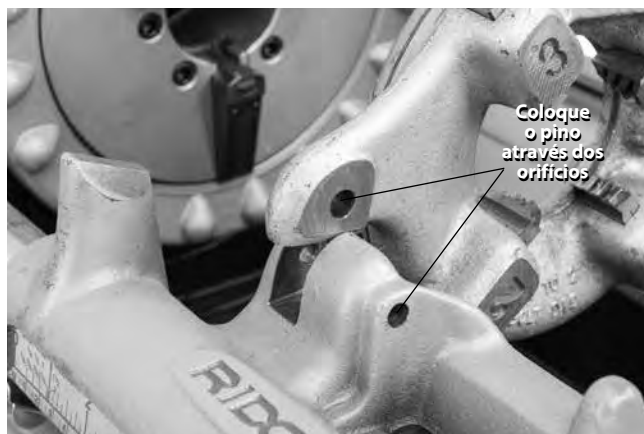
Figura 26 – Retenção da cabeça de tarraxa do lado esquerdo no lugar
