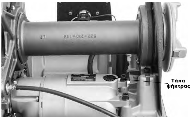
Εικόνα 34 – Αφαίρεση καλύμματος μοτέρ/αλλαγή ψηκτρών
