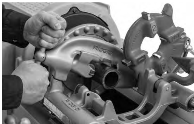
Εικόνα 21 – Κοπή σωλήνα με κόφτη
