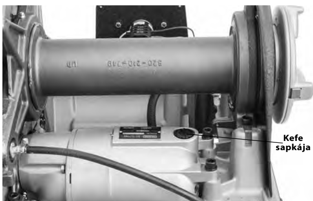
34. Ábra – Motor fedelének eltávolítása/szénkefe csere
