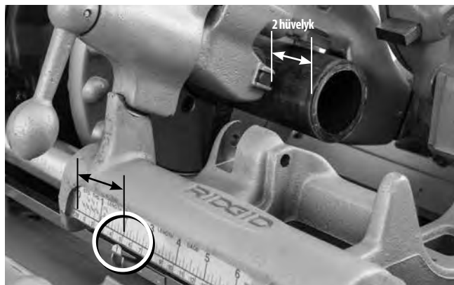
20 B Ábra – Hosszmérő mutató a kívánt hosszúságnál
