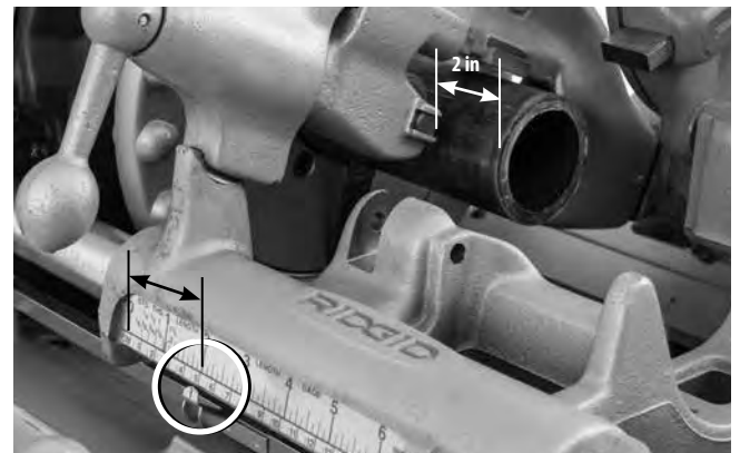
Slika 20B – Pokazivač merne skale na traženoj dužini
