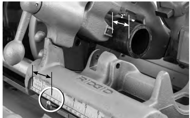
Abbildung 20B – Zeiger der Längenmessskala auf gewünschter Länge
