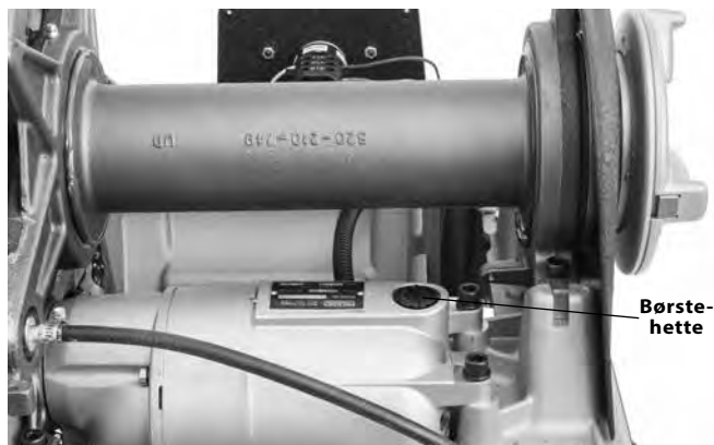
Figur 34 – Fjerne motordeksel / skifte børster
