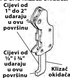
Slika 12 - Postavljanje klizača okidača
