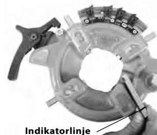
Figur 14 – Isättning av backar
