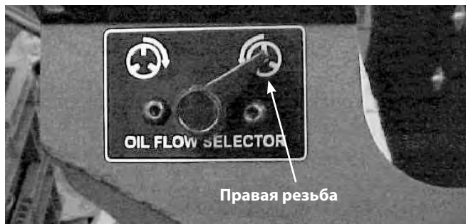
Рис. 24 – Переключатель потока масла для левой или правой резьбы
