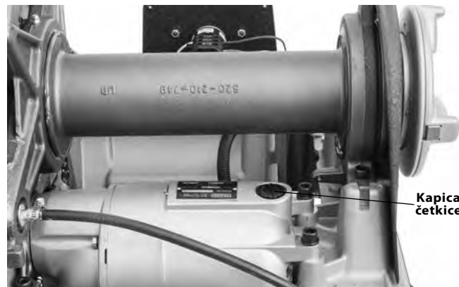
Slika 34 – Skidanje poklopca motora/promena četkica
