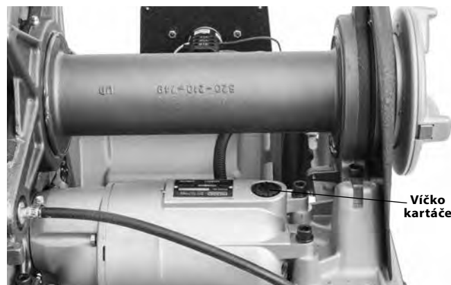
Obrázek 34 – Demontáž krytu motoru/Výměna kartáčů
