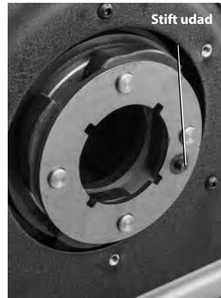
Figur 25B – Bageste drejestangsstøtte – Udskiftning af stift
