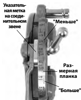
Рис. 7 – Настройка размера резьбы
