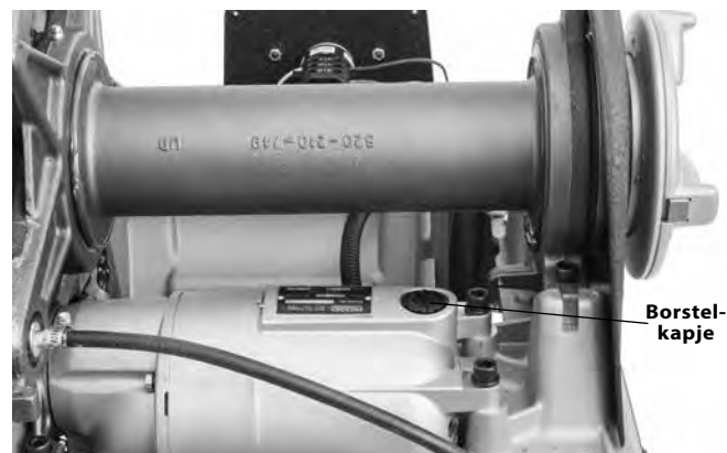
Figuur 34 – Verwijderen van de machinekap / vervangen van de borstels
