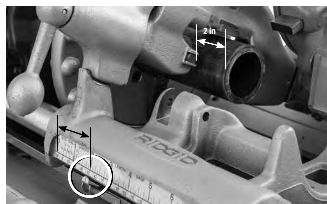
Figura 20B – Cursorul etalonului de lungime la lungimea dorită
