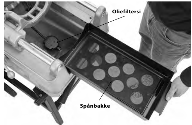
Figur 30 – Fjernelse af spånbakke
