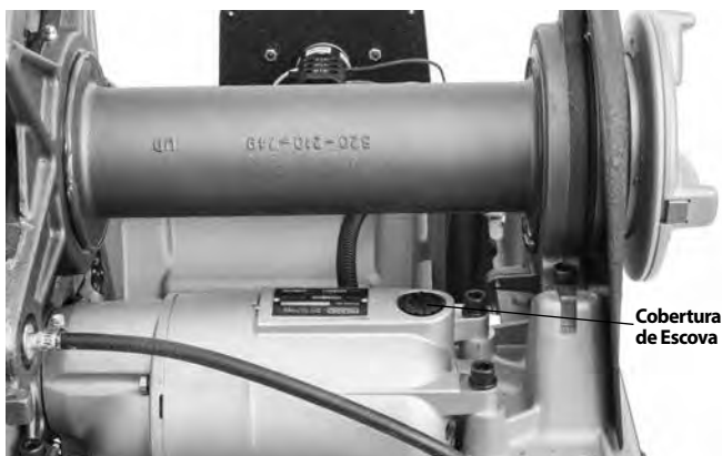
Figura 34 – Retirar tampa do motor/substituir escovas
