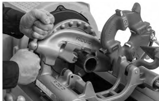
Figur 21 – Kapning av rör med avskärare
