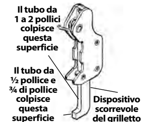
Figura 12 – Impostazione del Grilletto
