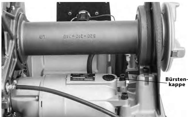
Abbildung 34 – Ausbau der Motorenabdeckung/Austausch der Bürsten
