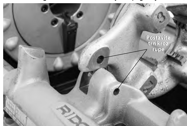
Slika 26 - Zadržavanje lijeve narezne glave na mjestu
