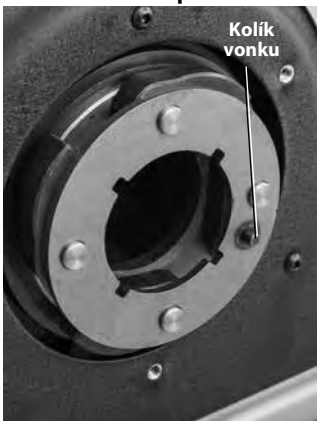
Obrázok 25B – Zadný držiak otočného čapu - poloha kolíkov
