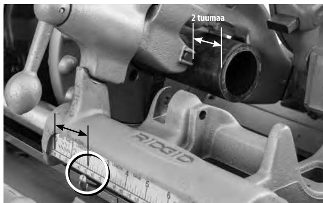
Kuva 20B – Pituustulkin osoitin halutussa pituudessa
