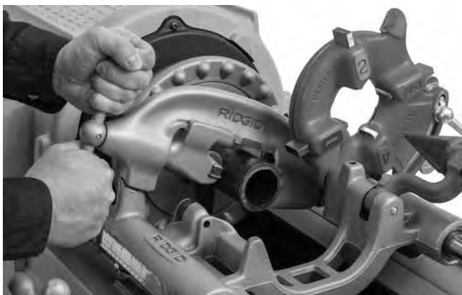
Figura 21 – Filetarea țevii cu un cuțit
