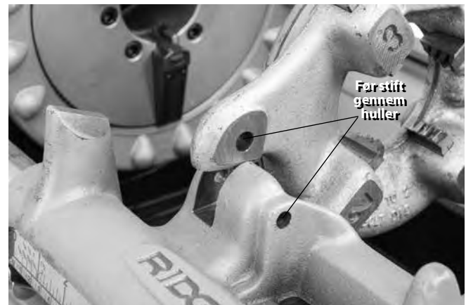
Figur 26 – Fastholdelse af venstre skærehoved
