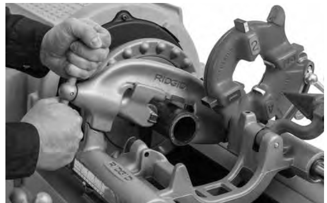
Figur 21 – Tilskæring af rør med rørskærer
