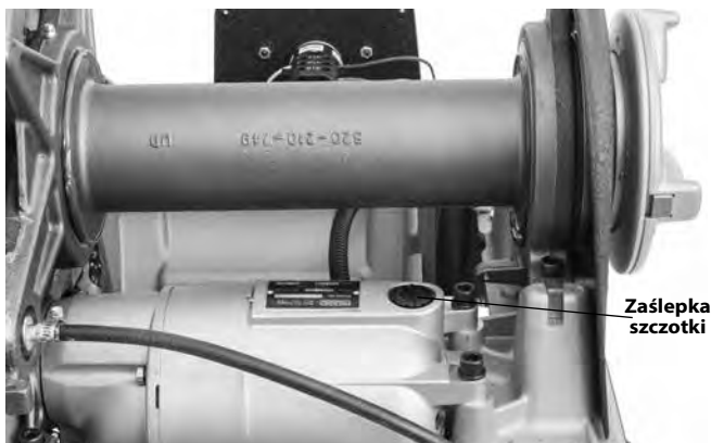
Rysunek 34 – Wymontowanie pokrywy silnika / wymiana szczotek
