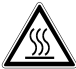
Advarsel mot varm overflate
