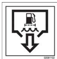
Polttoainesuodattimen vedenkerääjän tyhjennys
