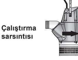
Pompa dönme yönünü kontrol edin (şekle bakınız). Çalıştırma anında, pompa, yukarıdan bakıldığından saatin aksi yönde sarsılacaktır.
