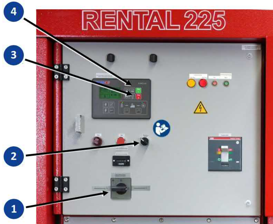
Kuva 7-2 Aggregaatin käynnistäminen ja sammuttaminen manuaalisesti
