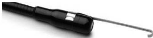
Obrázek 9 – Instalace příslušenství na zobrazovací zařízení opatřené konektorem v provedení „A“
