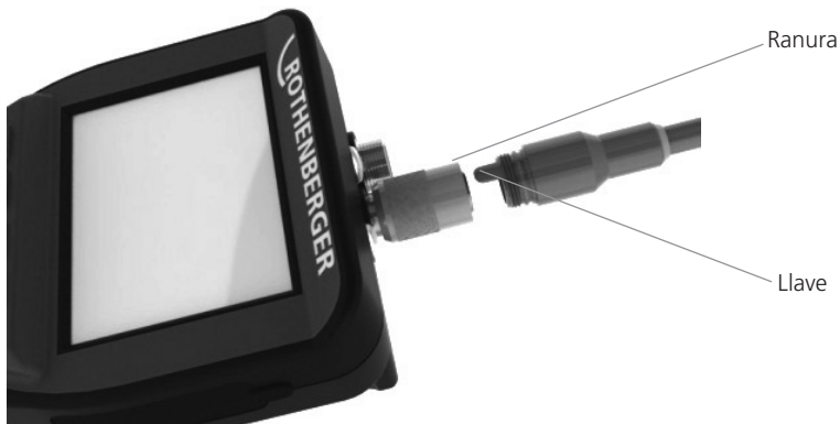
Figura 6 - Cableado (conector de tipo „A”, conector negro de 9 patillas)
