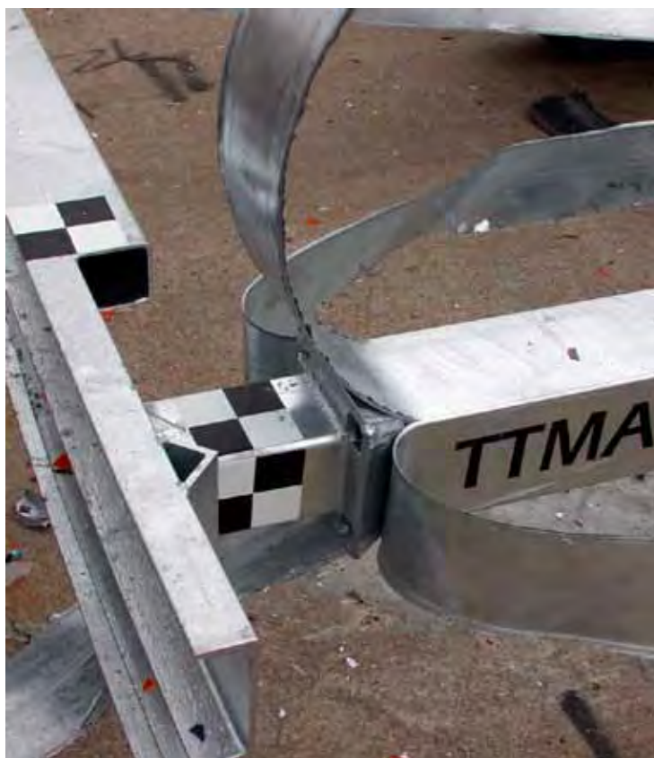
BILD 11: DE ENERGIABSORBERANDE RÖREN SPLITTRAS
