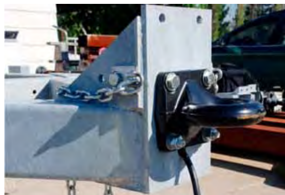
BILD 10: MONTERINGSLÄGE FÖR LUNETTRINGEN
