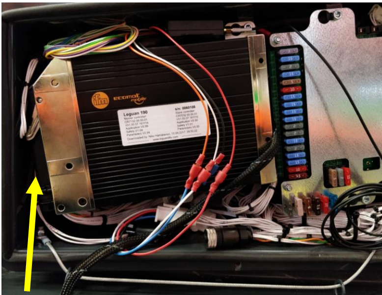
Kuva 32. Logiikkaohjaimien liittimet (2 kpl), osoitettu nuolella
