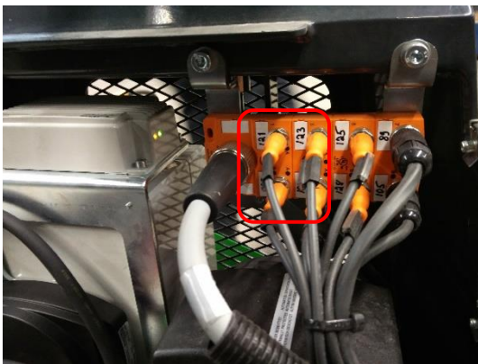
Kuva 23:Haaroitusrasia, tukijalkavalvonnan liittimet merkitty punaisen kehyksen sisään
