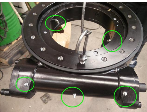
Kuva 15: Kääntökehän voitelupisteet, kehä kuvattuna yläpuolelta
