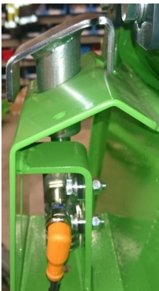
Kuva 28: Ylempi kuljetustuen anturi
