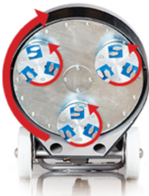
Figur 41 Illustrerar hur slipskivorna rör sig i förhållande till sliphuvudet.
