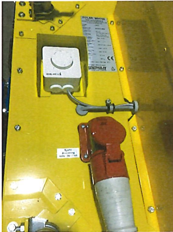
Potentiometri nopeuden säätöön sekä 16 A kojevastake syötölle
